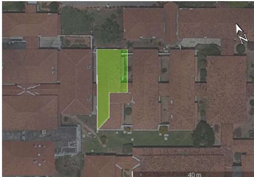
Figura 22 – Área de coleta captada por cada tubo de queda
