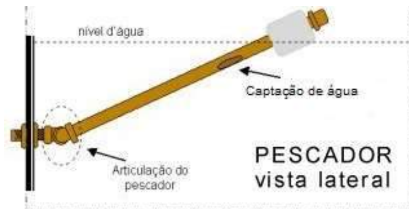
Figura 7 – Esquema de funcionamento do pescador
