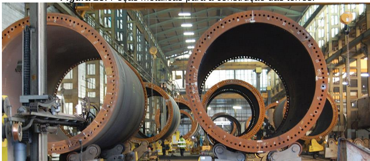
Figura 23: Peças metálicas para a construção das torres.
