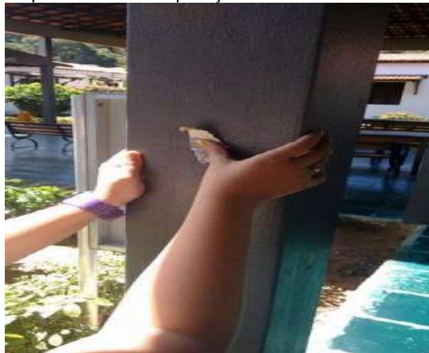
Figura 25 – Lixamento dos pilares antes da aplicação do esclerômetro.
