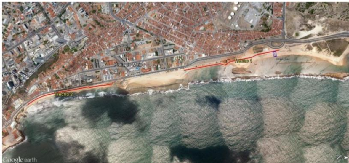
Figura 20 – Mapa de localização dos trechos de enrocamento aderente proposto para a Praia do Meio, separados entre si por área de estabilidade
