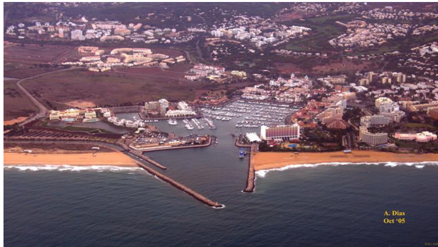
Figura 7 – Exemplo de molhe protegendo uma zona portuária
