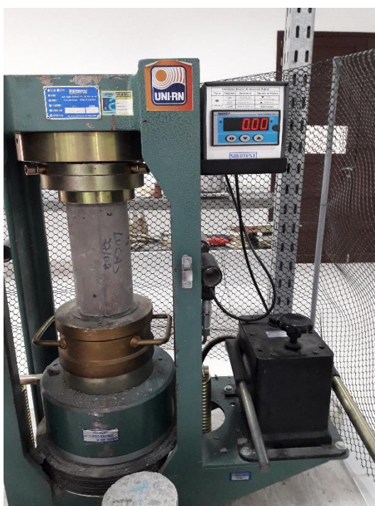
Figura 23 – Corpo de prova sendo submetido a compressão pela prensa
