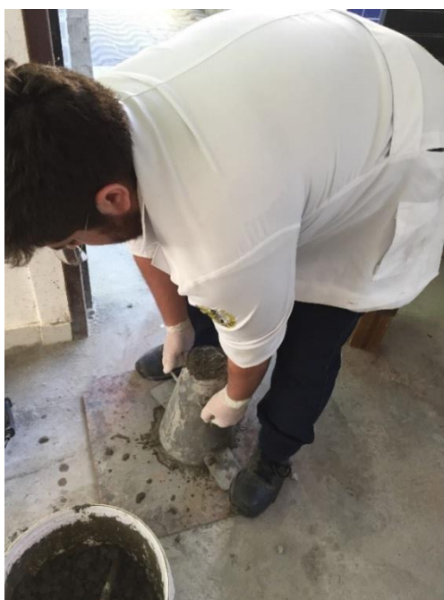
Figura 15 – Ensaio de abatimento sendo realizado
