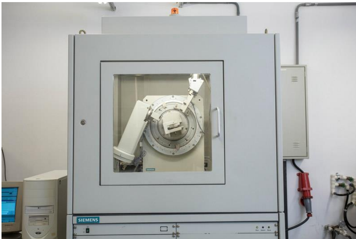
Figura 10 – Equipamento utilizado para ensaio de difração de raio X
