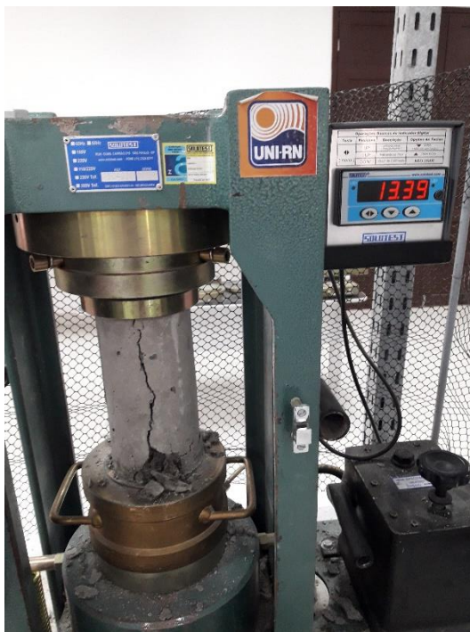
Figura 30 – Ruptura tipo cônica e bipartida
