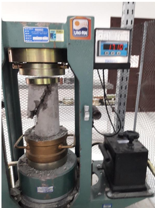
Figura 31 – ruptura por cisalhamento
