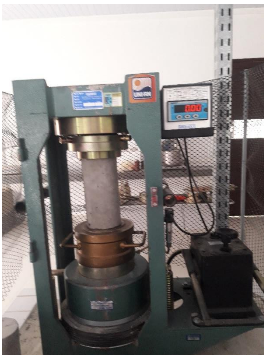
Figura 19 – Corpo de prova de concreto sofrendo com esforço de compressão
