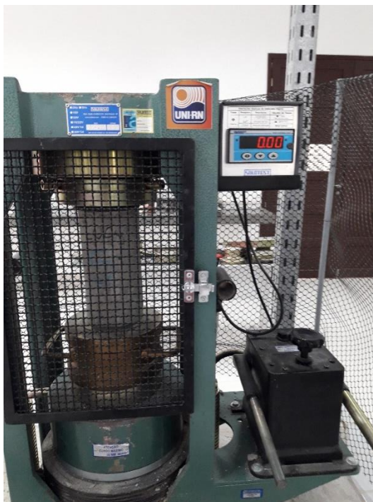
Figura 20 – Corpo de prova de concreto sofrendo com esforço de compressão
