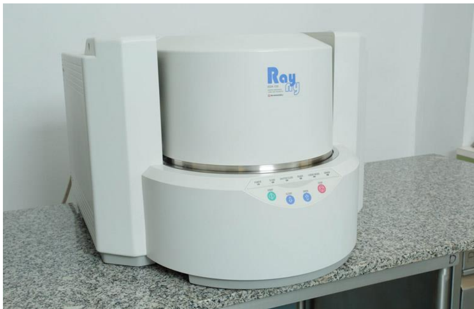
Figura 9 – Equipamento utilizado para ensaio de FRX
