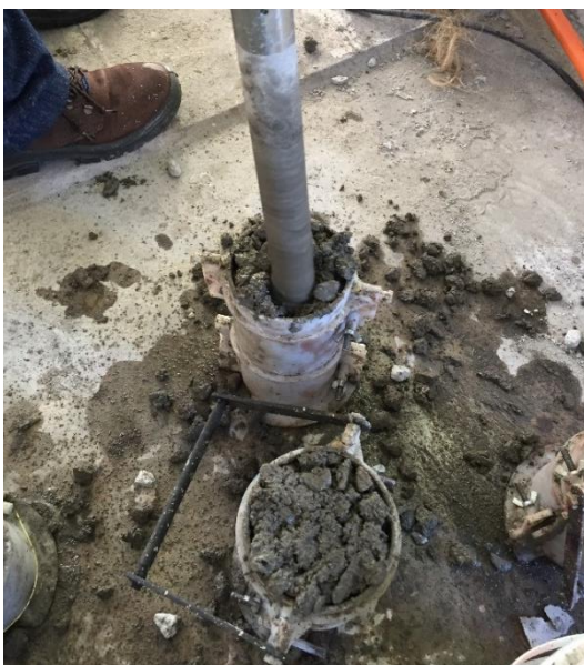
Figura 17 – Corpo de prova sendo adensado
