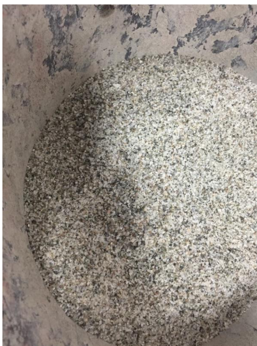
Figura 14 – Rejeito proveniente da Scheelita utilizado no traço.
