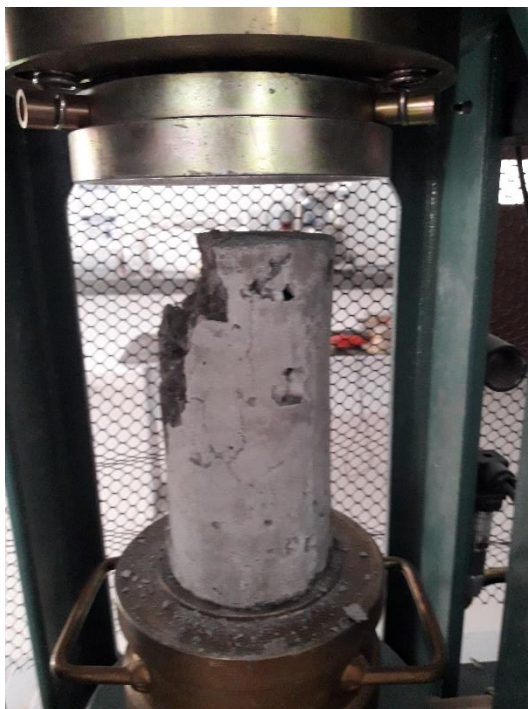
Figura 28 – ruptura de fratura no topo
