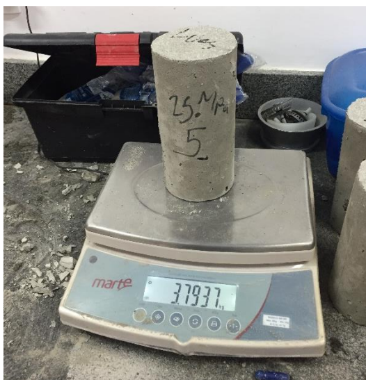
Figura 26 – Corpo de prova sendo pesado antes da cura
