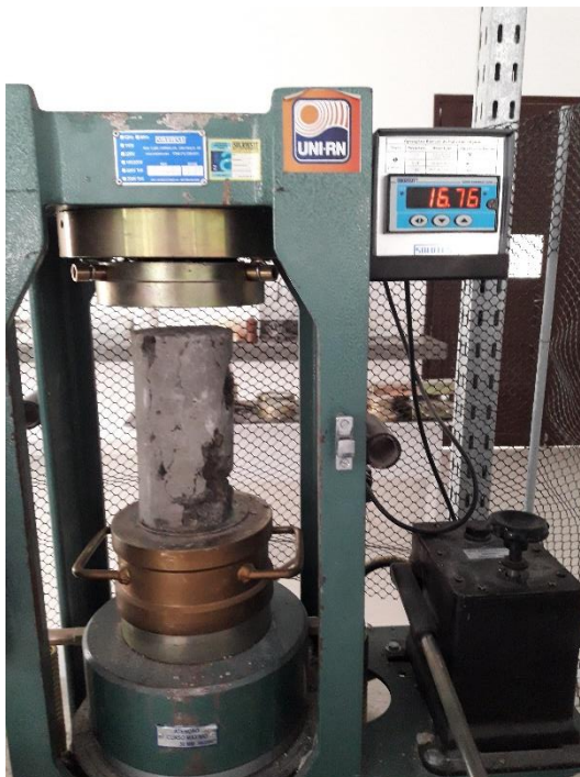
Figura 29 – ruptura de fratura de base
