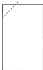
Figura A.6 – Tipo F – Fraturas no topo e/ou na base abaixo do capeamento
