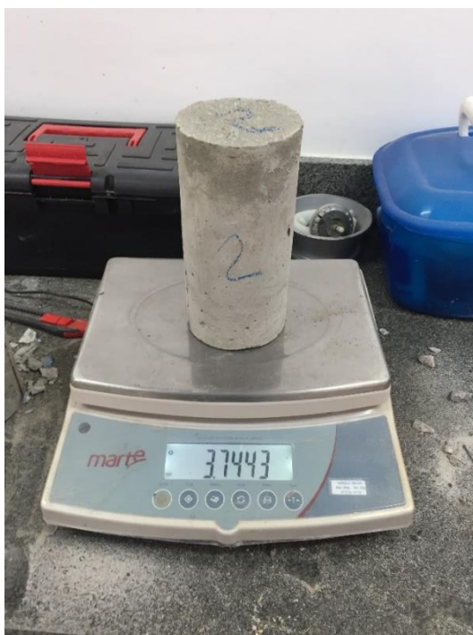
Figura 18 – Pesagem do corpo de prova depois de desmoldado
