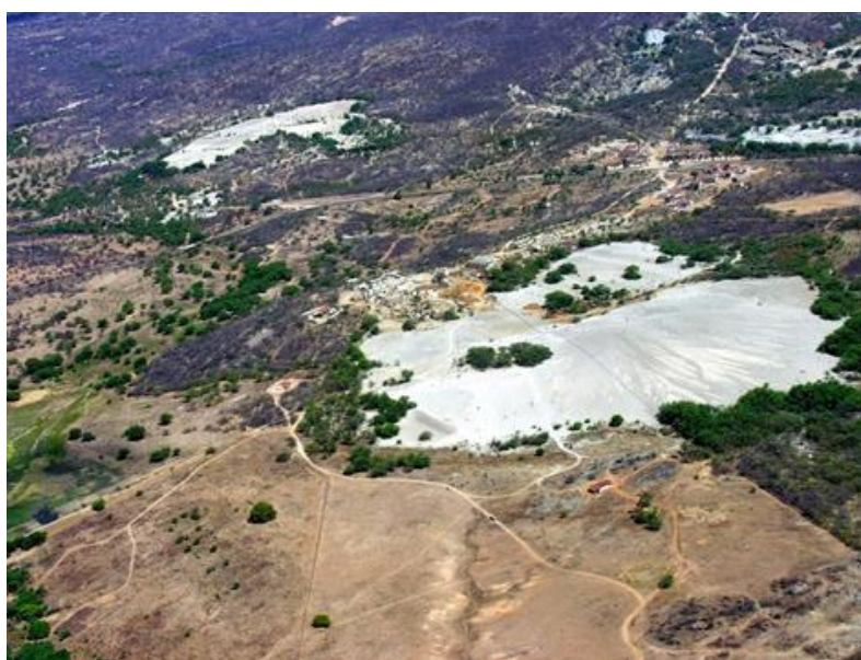
Figura 5 – Vista aérea dos montes de rejeitos provenientes da extração da Scheelita na Mina Brejuí
