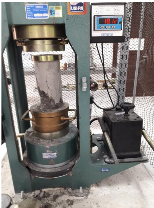
Figura 24 – Corpo de prova após o rompimento
