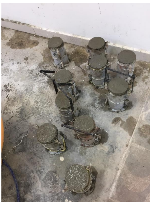
Figura 12 – Corpos de prova em processo de moldagem
