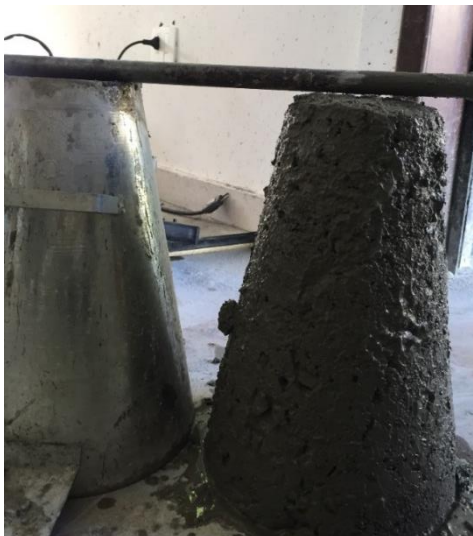
Figura 16 – Ensaio de abatimento após retirada do cone
