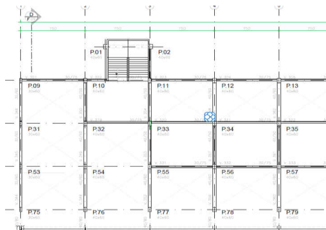
Figura 38- Detalhe do projeto estrutural dos pilares
