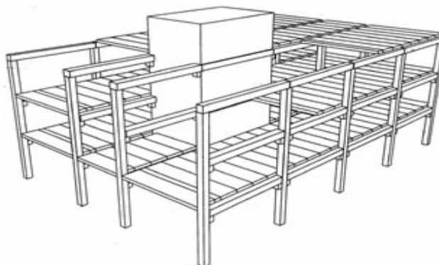
Figura 6- Estrutura pré-moldada em esqueleto
