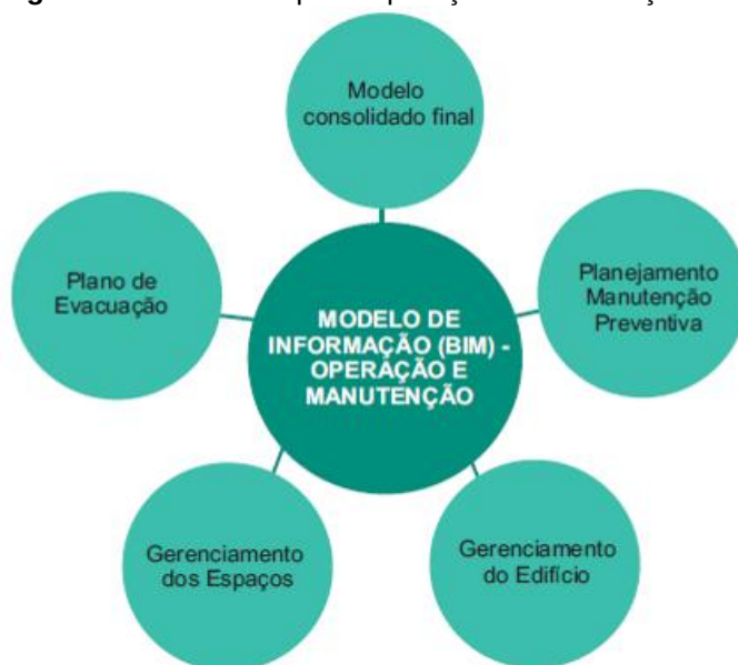
Figura 7: Uso do BIM para Operação e Manutenção
