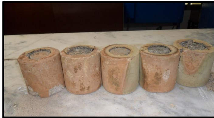
Figura 26 – Corpo de prova reforçado por MFC com a proteção passiva de concreto projetado vermiculítico após o ensaio
