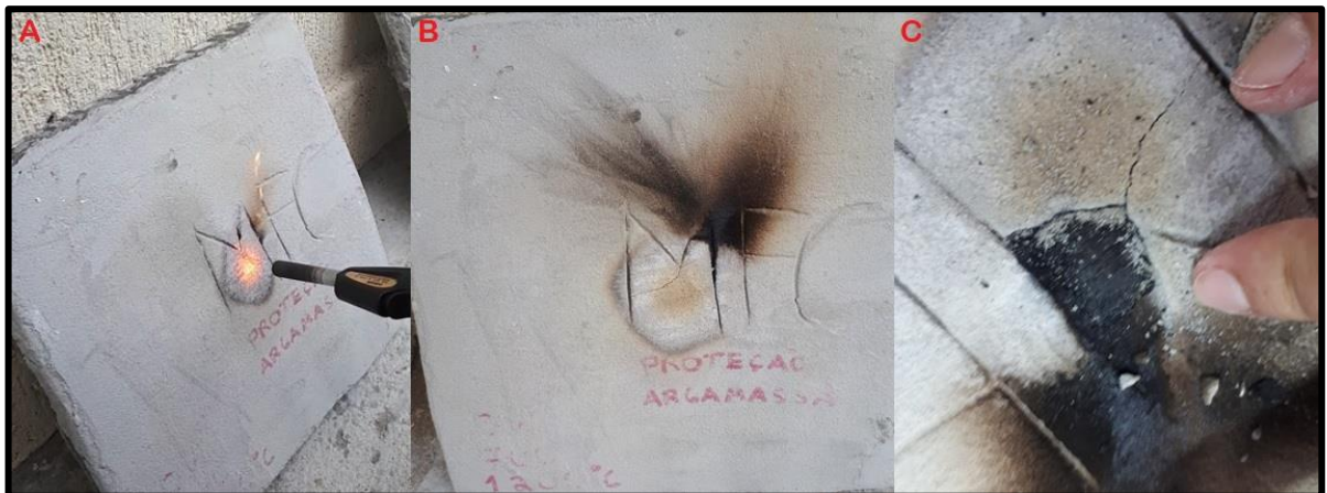
Figura 44 – Placa de concreto reforçado com MFC com argamassa como proteção passiva
