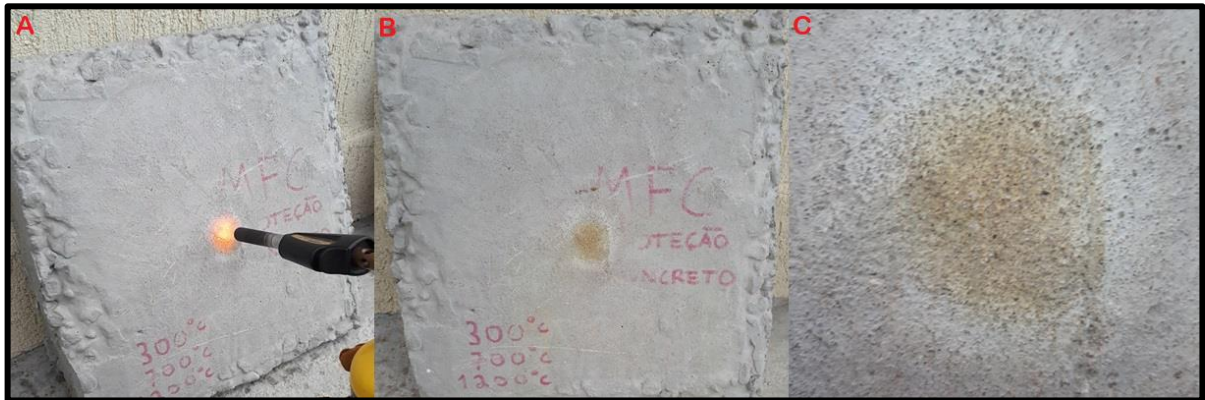
Figura 42 – Placa de concreto reforçado com MFC com concreto como proteção passiva
