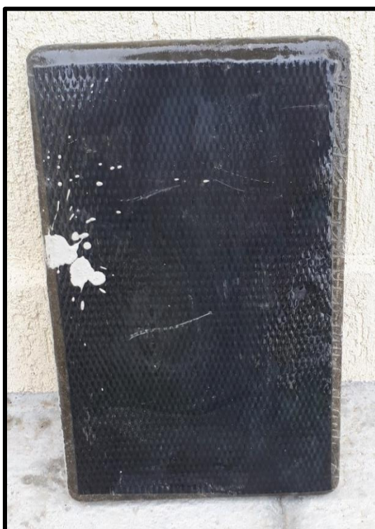
Figura 2 – Placa de concreto reforçado com manta de fibra de carbono (MFC)
