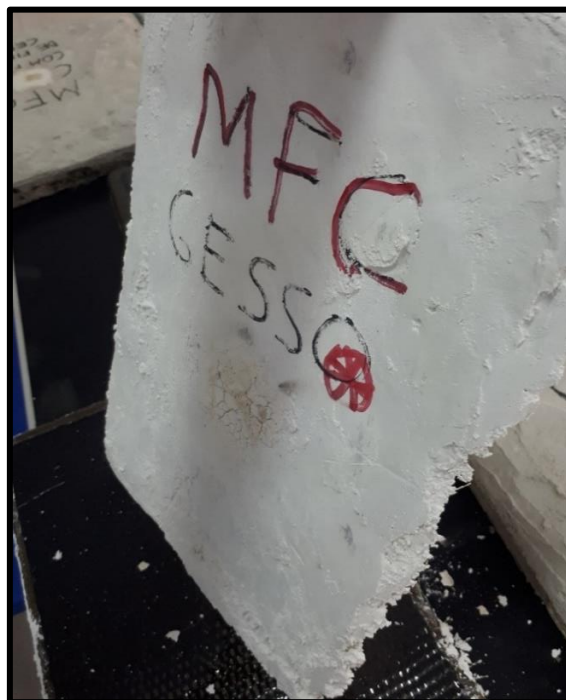
Figura 48 – Desprendimento do gesso da placa de concreto reforçado com MFC pós ensaio
