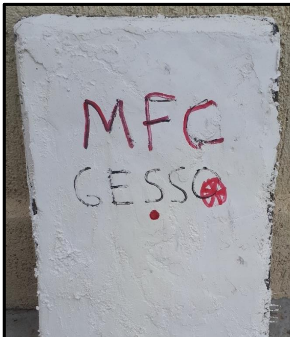
Figura 8 – Placa de concreto reforçado com MFC com gesso como proteção passiva
