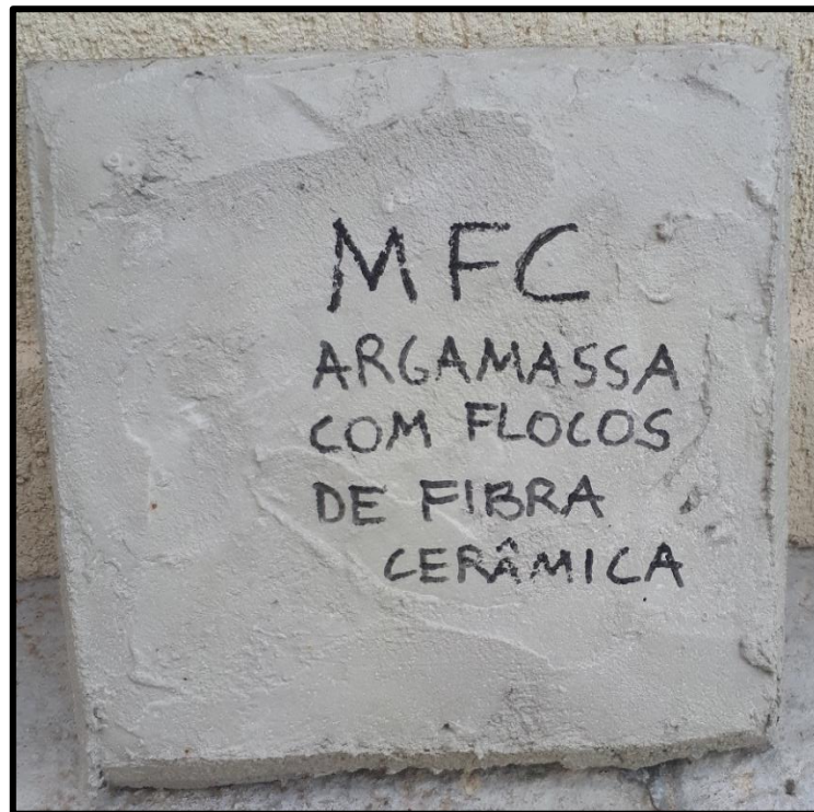
Figura 6 – Placa de concreto reforçado com MFC com argamassa com floco de cerâmica como proteção passiva
