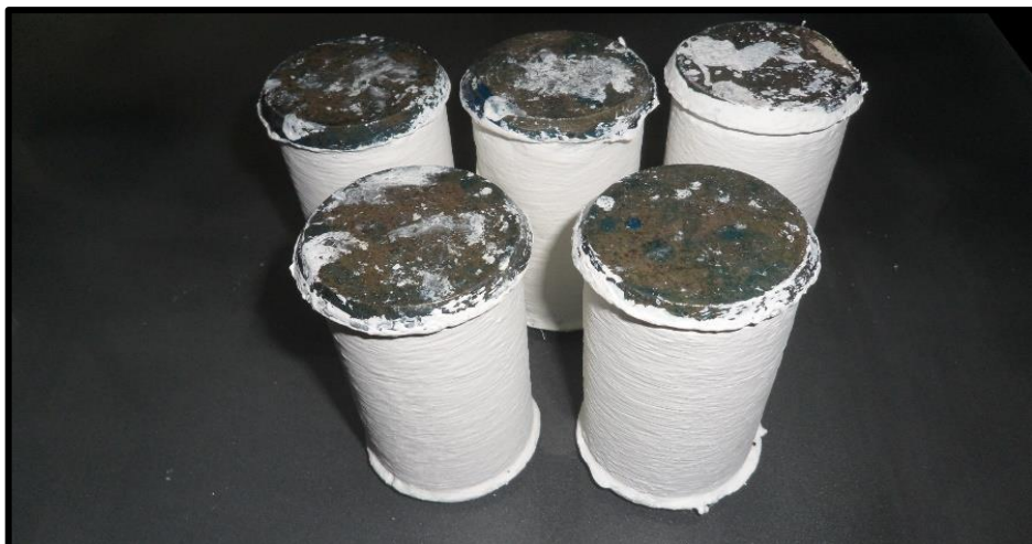
Figura 28 – Corpo de prova reforçado por MFC com a proteção passiva de pintura intumescente
