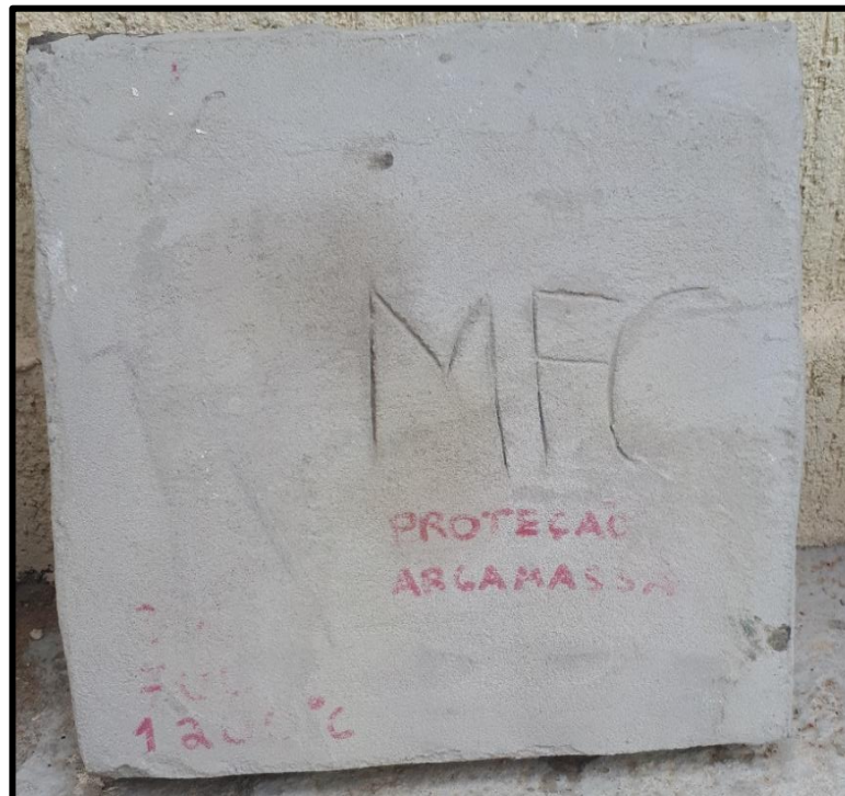
Figura 5 – Placa de concreto reforçado com MFC com argamassa como proteção passiva
