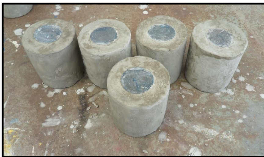
Figura 25 – Corpo de prova reforçado por MFC com a proteção passiva de concreto projetado vermiculítico
