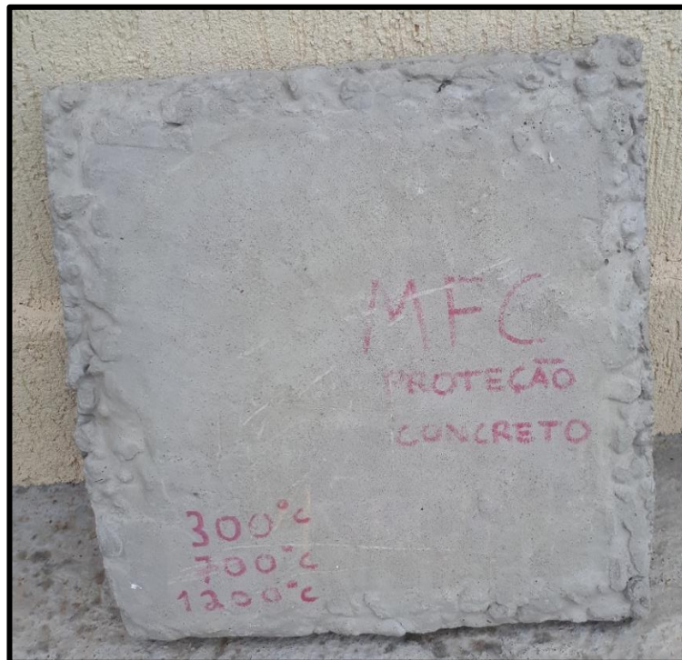
Figura 3 – Placa de concreto reforçado com MFC com concreto como proteção passiva
