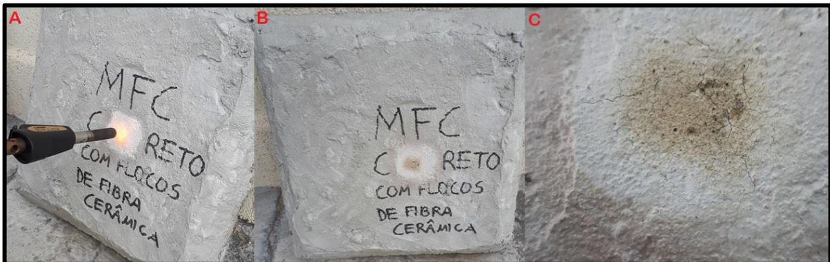
Figura 43 – Placa de concreto reforçado com MFC com concreto com floco de fibra de cerâmica como proteção passiva durante e pós ensaio
