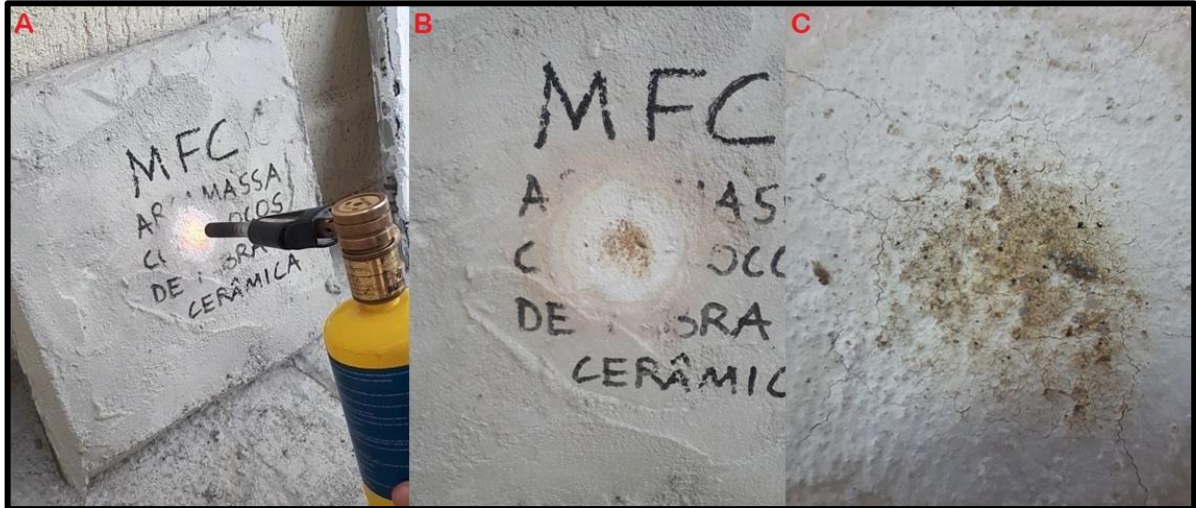
Figura 45 – Placa de concreto reforçado com MFC com argamassa com floco de cerâmica como proteção passiva durante e pós ensaio
