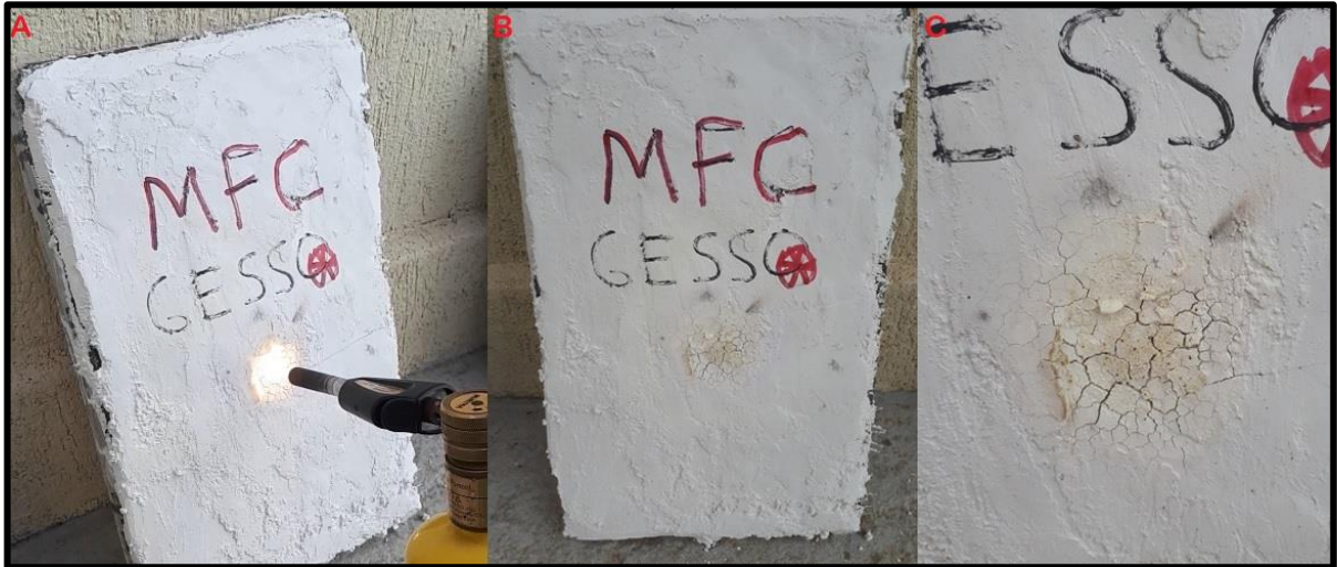
Figura 47 – Placa de concreto reforçado com MFC com gesso como proteção passiva
