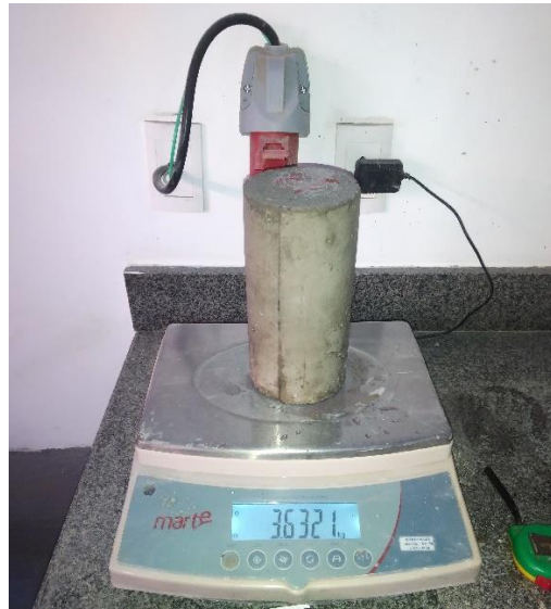
Figura 11 – Corpo de prova sendo pesado após 24h submerso
