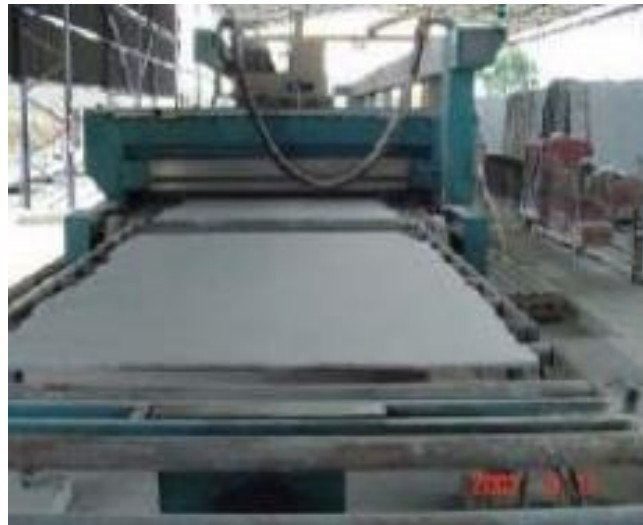
Figura 26 – Chapa bruta passando pelo processo de beneficiamento.
