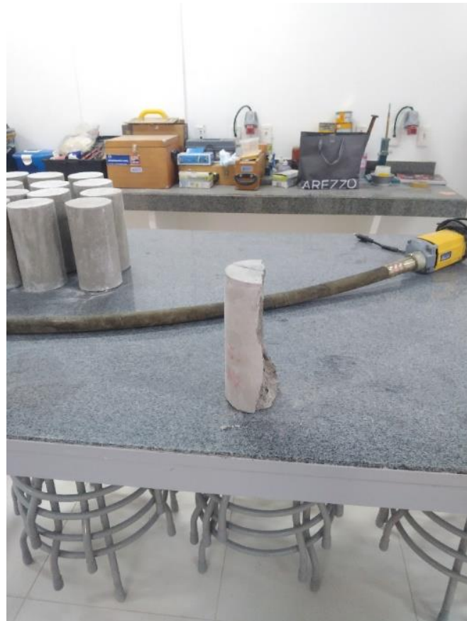
Figura 13 – Corpo de prova rompido
