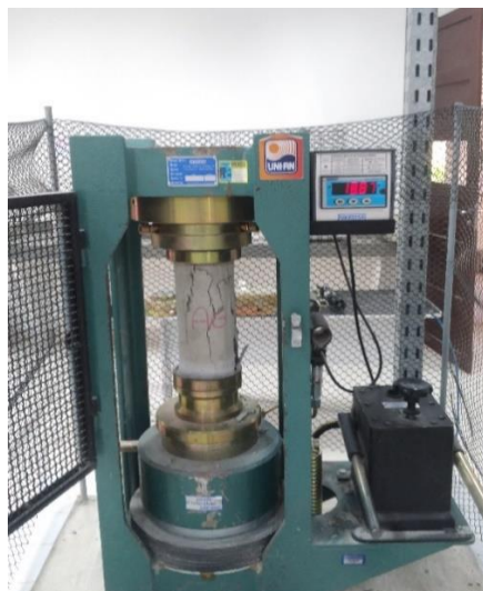
Figura 12 – Corpo de prova rompido na prensa hidráulica
