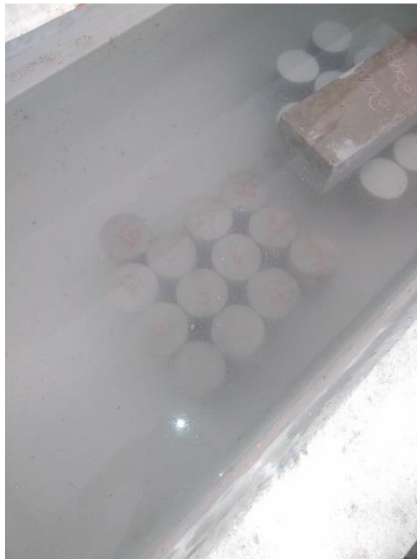
Figura 10 – Corpos de prova submersos no tanque com água.
