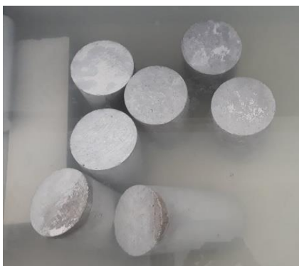
FIGURA: 5. Cps em tanque para cura de 28 dias.
