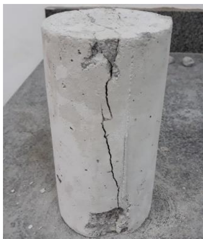
FIGURA: 9. Corpo de prova fissurado.
