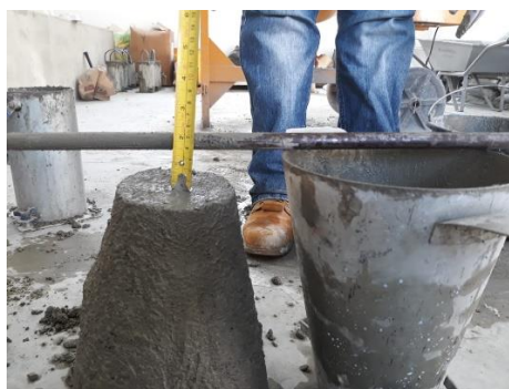
FIGURA: 2. Ensaio de abatimento de tronco de cone.
