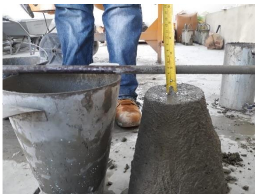
FIGURA: 17. Ensaio de abatimento com tronco de cone.
