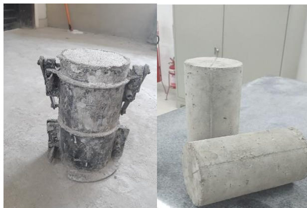
FIGURA: 3. Molde para corpo de prova / Corpo de prova.
