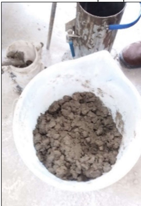
Figura 41 – Detalhe do concreto finalizado pronto para moldagem
