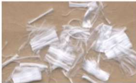
Figura 21 - Fibras sintéticas de polipropileno para uso no concreto
