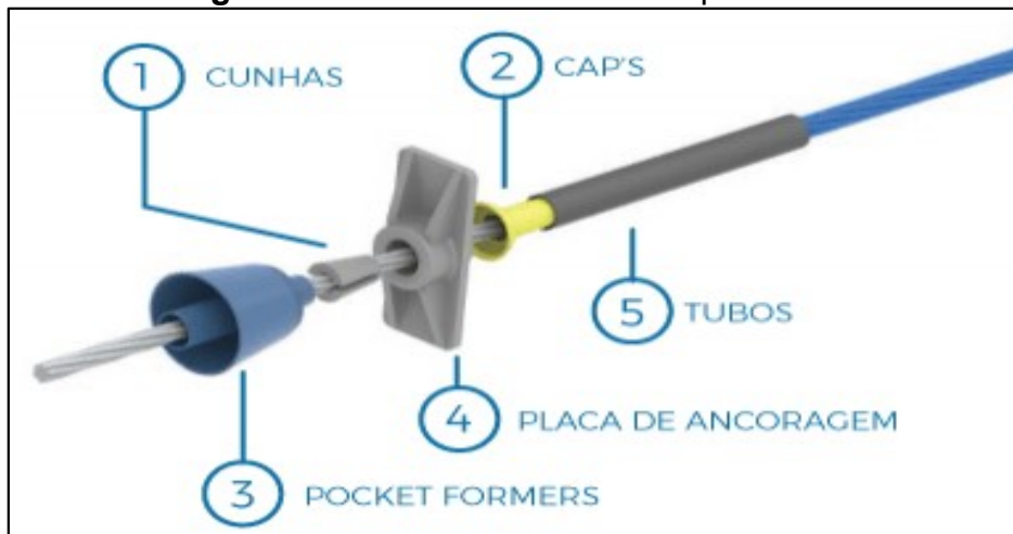
Figura 14 - Partes do sistema de protensão
