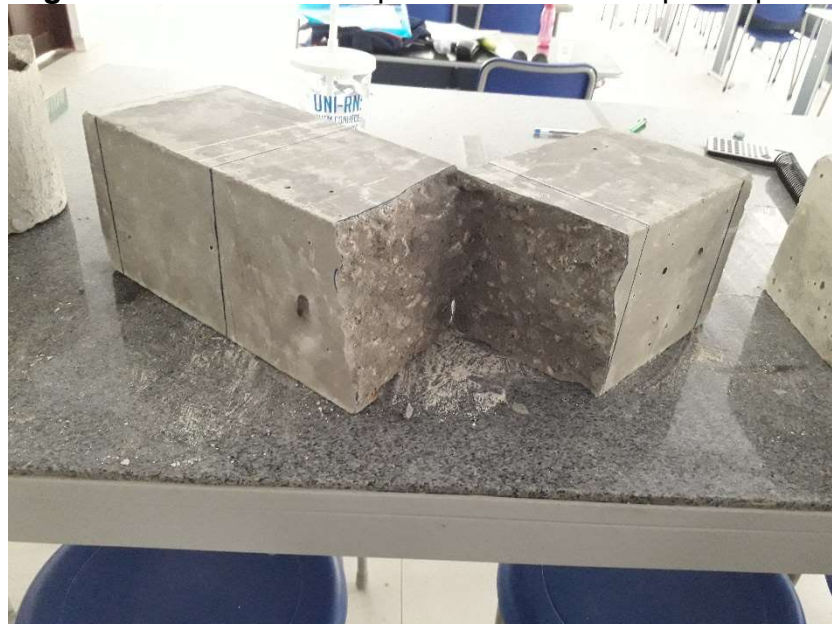
Figura 43 - Detalhe da ruptura de um dos corpo-de-prova
