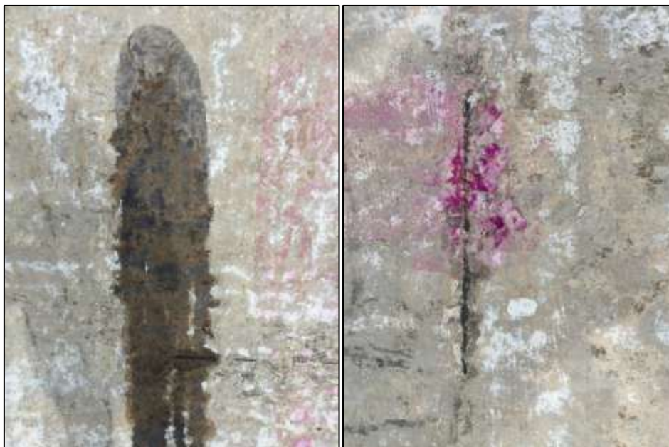
Figura 46 A e 46 B – Vista da aspersão de nitrato de prata e fenolftaleína, respectivamente.
