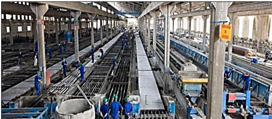
Figura 15 – Fábrica de confecção de pré-moldados em CP com pré-tensão.
