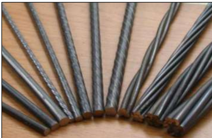
Figura 24: Barras e cordoalhas para concreto protendido.
