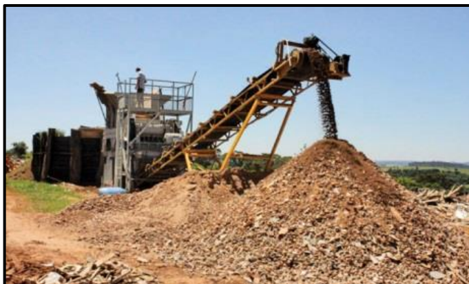
Figura 28 – Equipamento de moagem e separação dos resíduos de construção.
