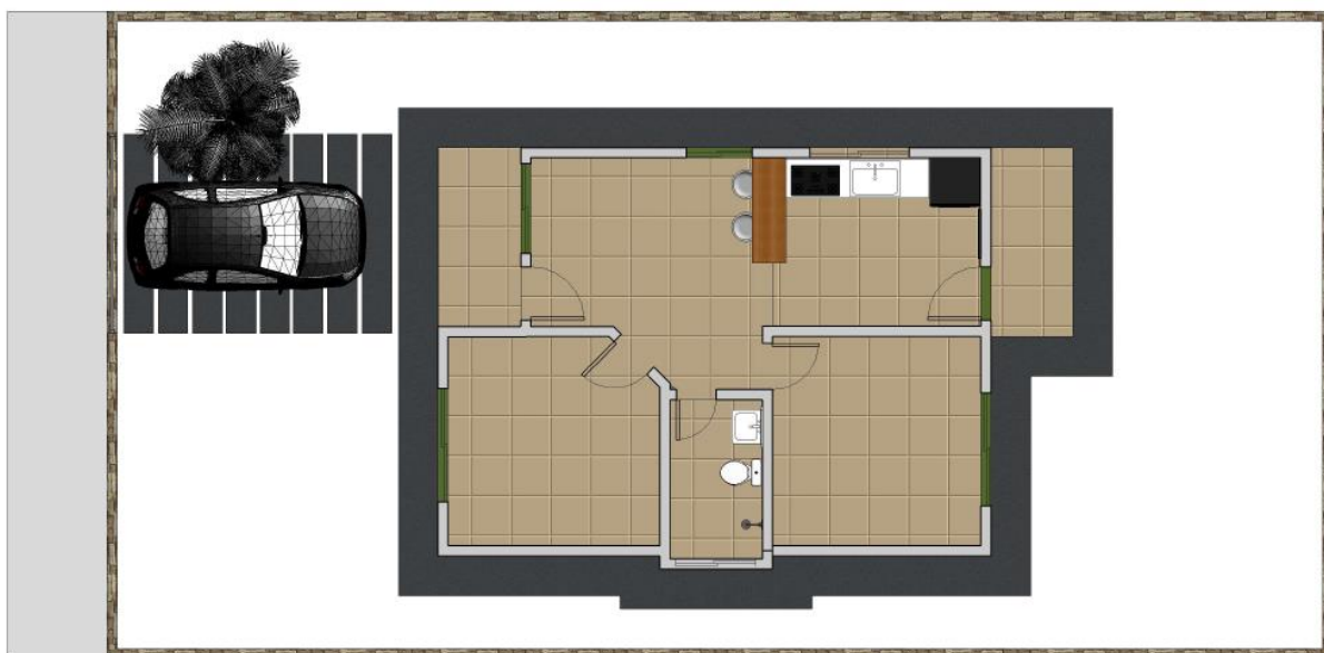
Figura 14 – Planta baixa residência unifamiliar.
