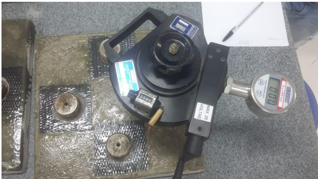
Figura 29 – Equipamento de pull-off .
