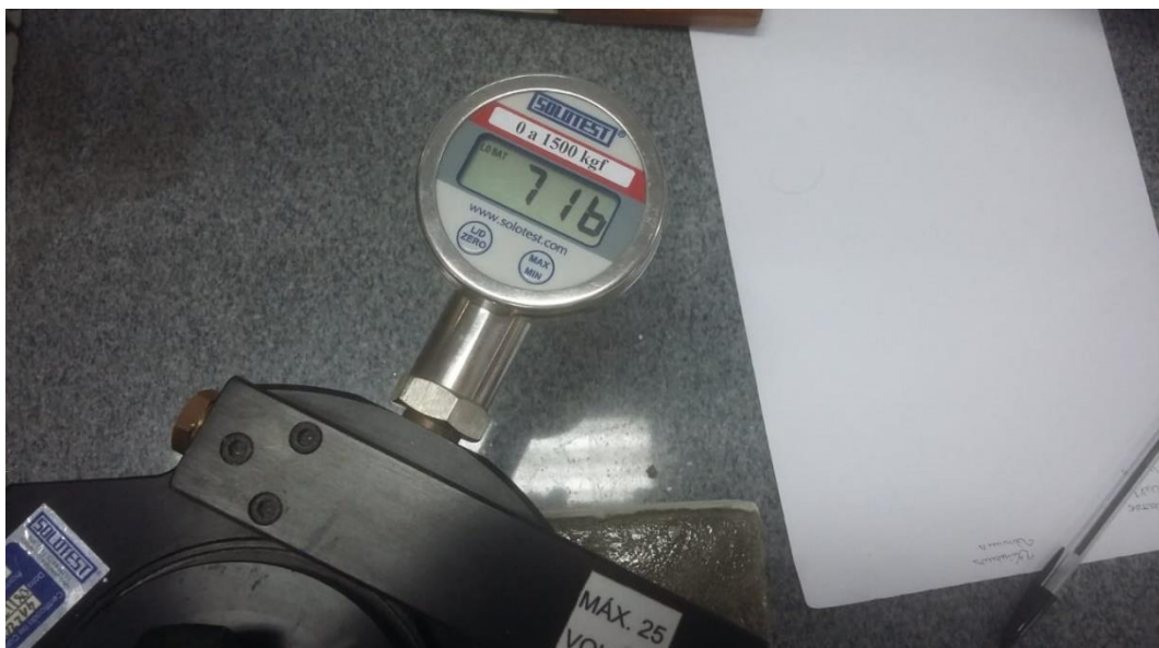
Figura 53 – Força de tração necessária para o arrancamento da lâmina L1 da placa de concreto 04
