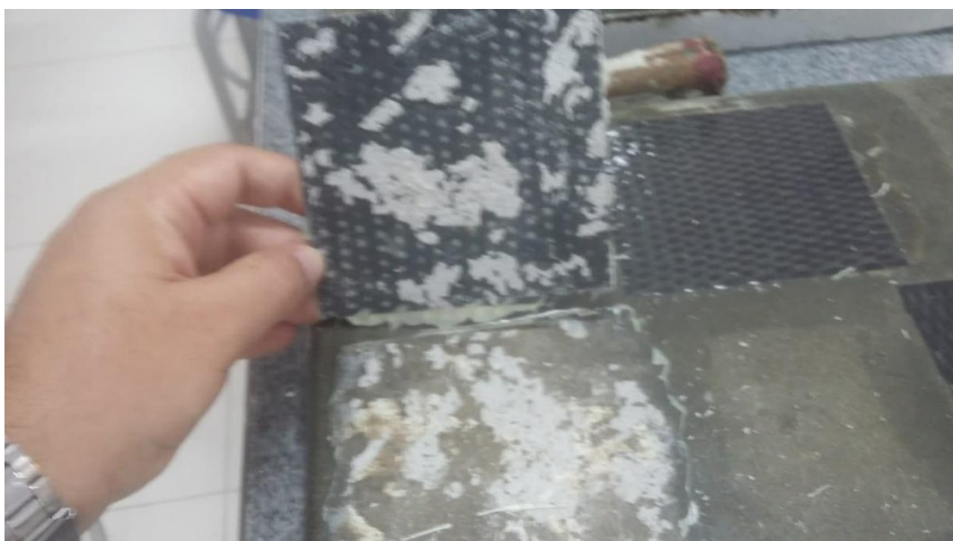
Figura 37 – Aspectos da superfície lâmina L1 e do substrato da placa de concreto 01 pós-ensaio.
