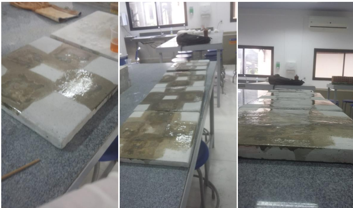
Figura 27 – Outras vistas mostrando os detalhes das placas após a aplicação do primer epóxi.
