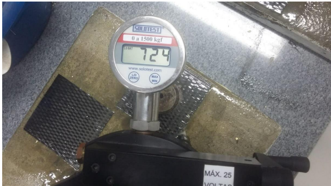
Figura 56 - Força de tração necessária para o arrancamento da lâmina L2 da placa de concreto 04.
