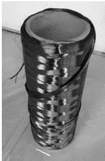
Figura 2 – Fibras de carbono longas e contínuas enroladas em carretel.
