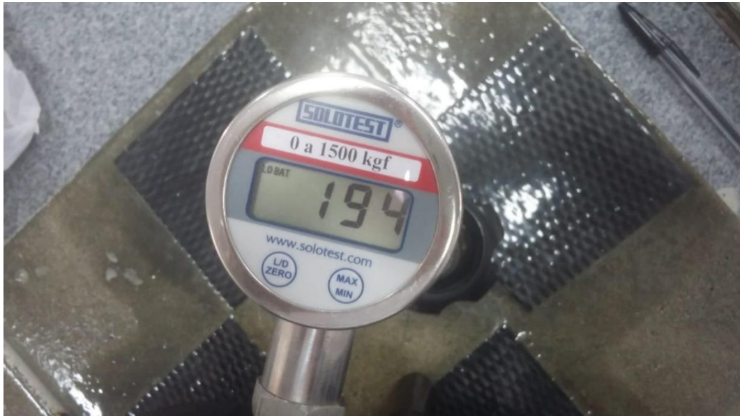
Figura 36 – Força de tração necessária para o arrancamento da lâmina L1 da placa de concreto 01.
