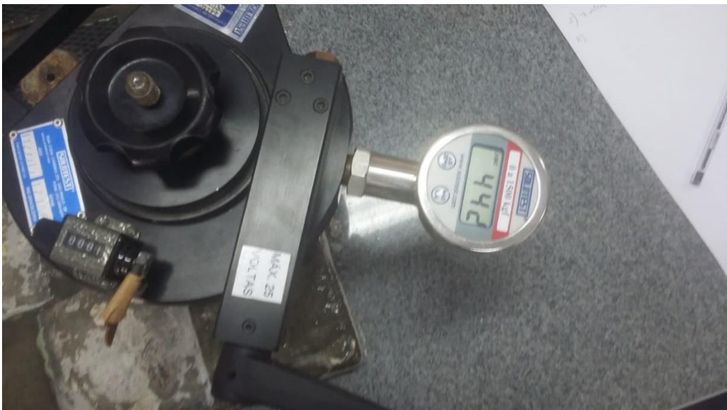
Figura 43 – Força de tração necessária para o arrancamento da lâmina L3 da placa de concreto 01.
