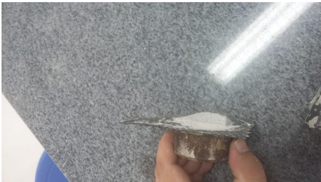
Figura 50 – Volume de concreto aderido na lâmina L3 da placa de concreto 03 pós-ensaio.
