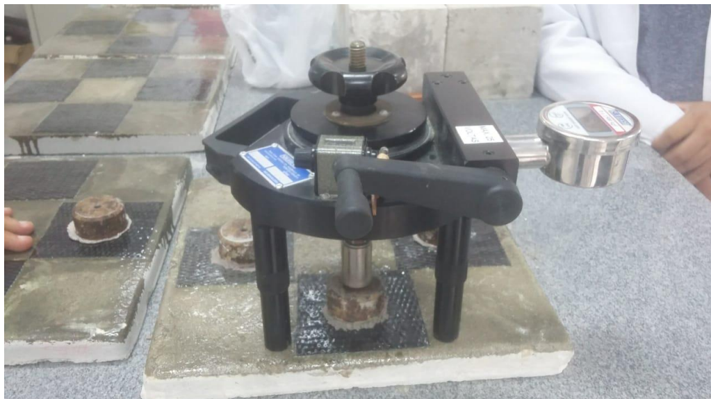
Figura 33 – Equipamento de pull-off .
