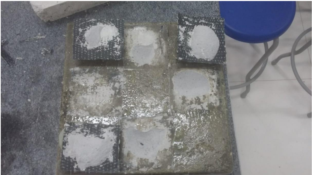
Figura 60 – Placa de concreto 04 pós-ensaio.
