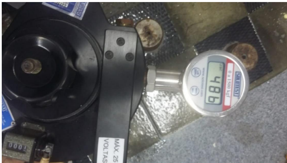
Figura 44 – Força de tração necessária para o arrancamento da lâmina L4 da placa de concreto 01.
