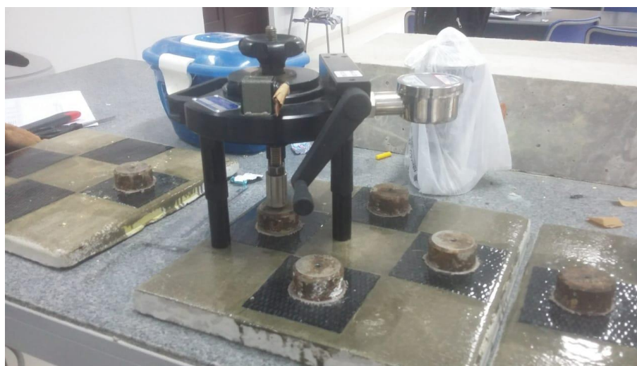
Figura 21 – Equipamento de para ensaio de tração direta via pull-off .
