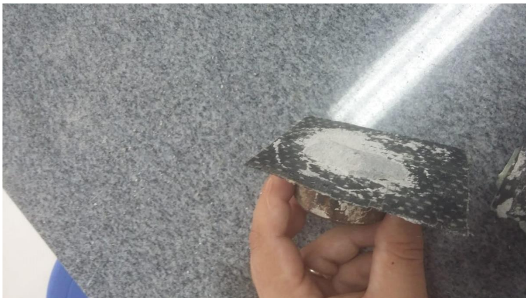
Figura 47 – Volume de concreto aderido na lâmina L1 da placa de concreto 02 pós-ensaio.
