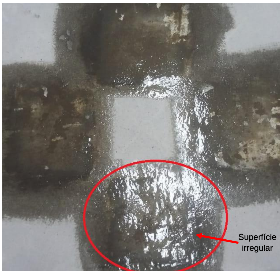
Figura 51 – Placa de concreto 04, detalhe para o local onde ficou aderida a lâmina de fibra de carbono L3.
