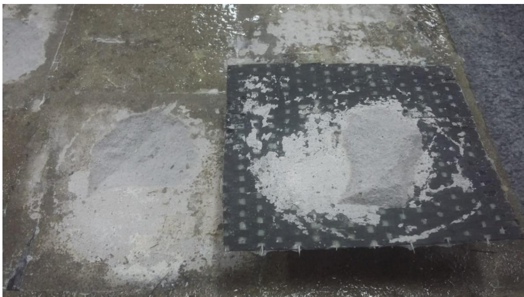
Figura 59 – Aspectos da superfície da lâmina L4 e do substrato da placa de concreto 04 pós-ensaio.
