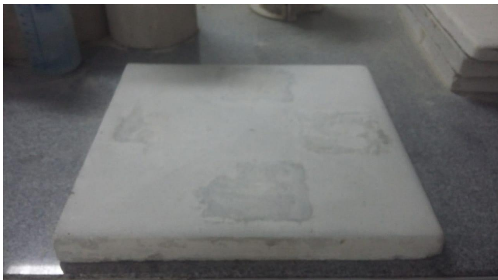
Figura 24 – Superfície de uma das placas após a etapa de lixamento.
