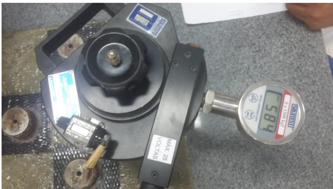
Figura 46 – Arrancamento por aderência da lâmina L1 da placa de concreto 02.
