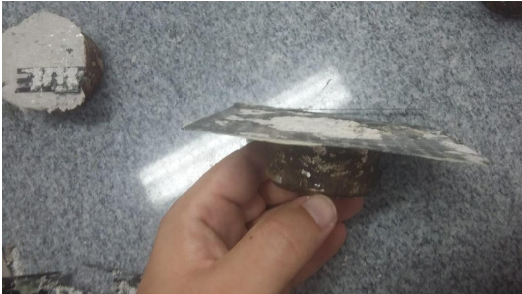
Figura 40 – Volume de concreto aderido na lâmina L2 da placa de concreto 01 pós-ensaio.
