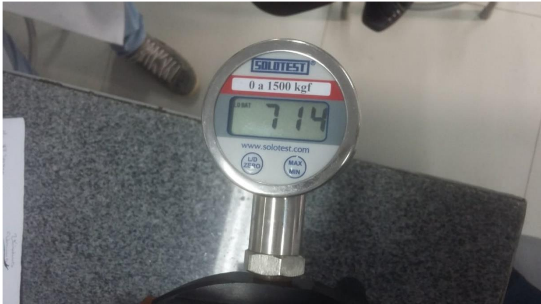
Figura 58 – Força de tração necessária para o arrancamento da lâmina L4 da placa de concreto 04.
