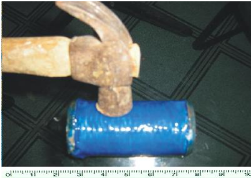
Figura 22 – Ensaio de sondagem acústica.
