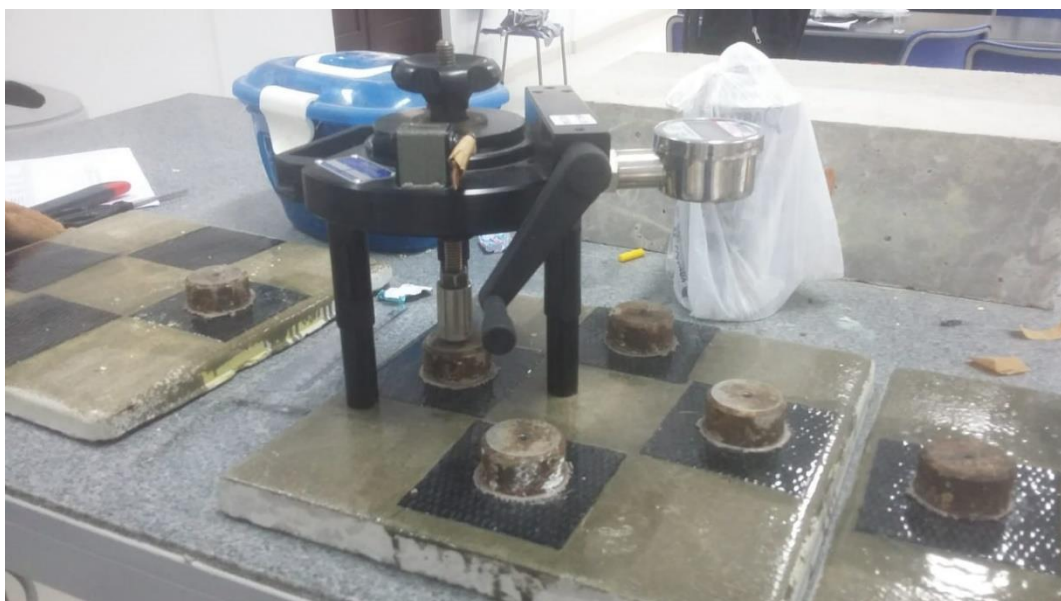
Figura 49 – Preparação para o ensaio da lâmina L3 da placa de concreto 03.
