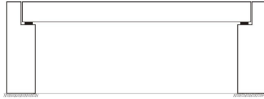
Figura 25 – Esquema de ponte simplesmente apoiada por um único vão
