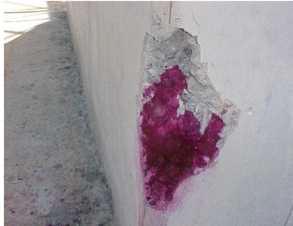
Figura 59 – Representação de carbonatação na parte com coloração incolor após aspersão com solução de nitrato de prata
