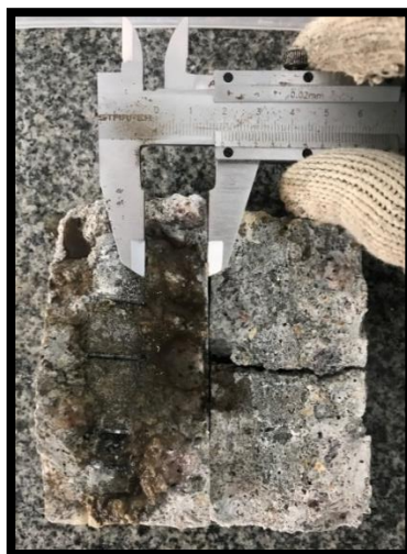
Figura 28 – Amostra de concreto com o envelopamento de alumínio.
