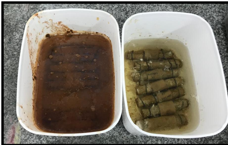
Figura 32 – Barras em ácido clorídrico a 0,05mol/L após dois meses.
