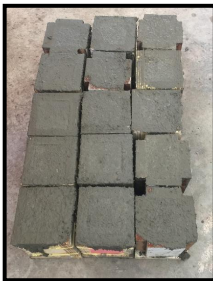
Figura 26 – Amostras de concreto nos moldes secando.
