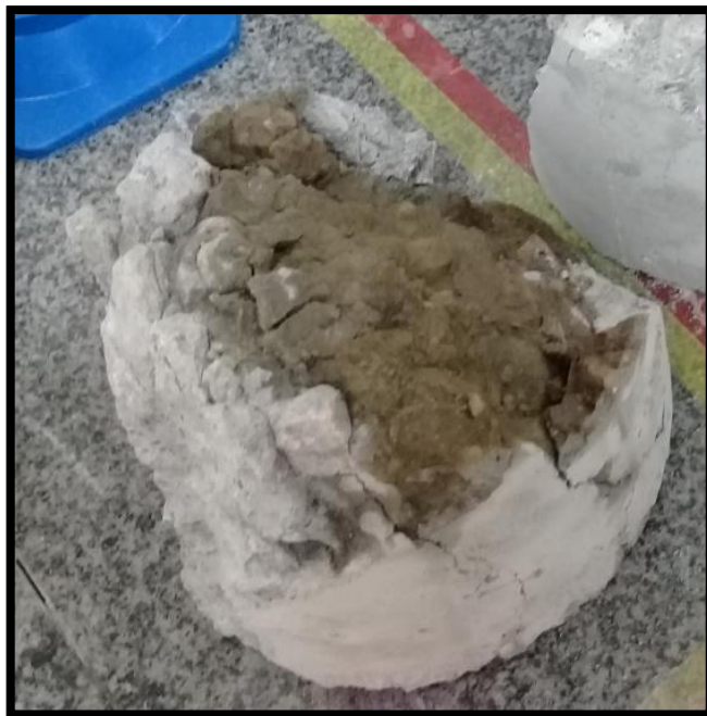
Figura 6 – Amostra submetida à solução de nitrato de prata a 1% com presença de cloretos.
