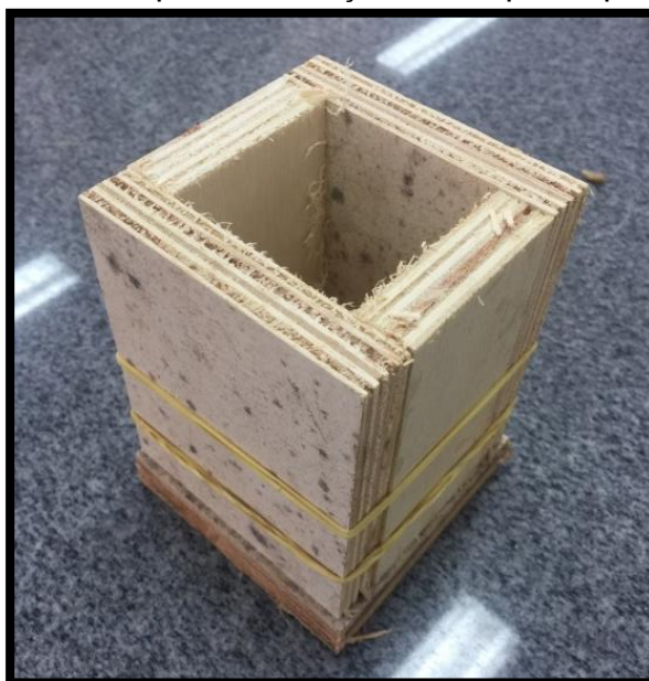
Figura 24 – Molde para confecção do corpo de prova.
