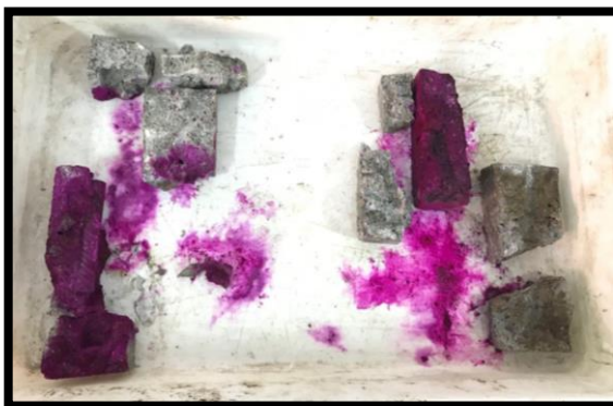
Figura 27 - Ensaio de carbonatação
