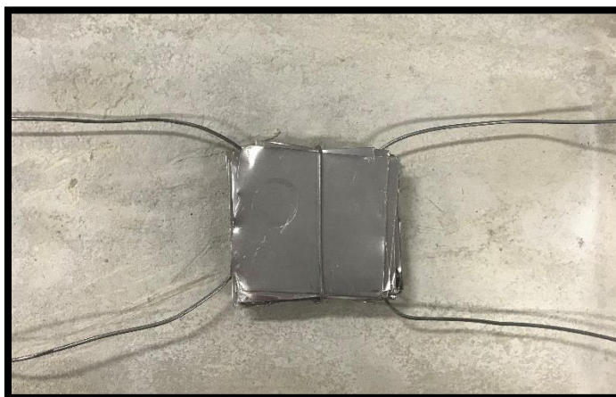
Figura 34 – Pastilha Galvânica de Alumínio
