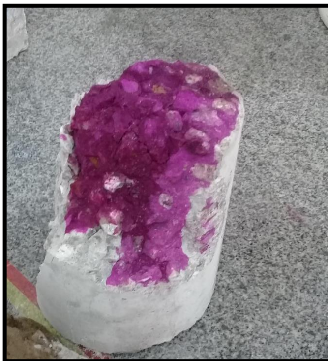
Figura 7 – Amostra submetida a solução de fenolftaleína a 1% com inexistência de carbonatação.
