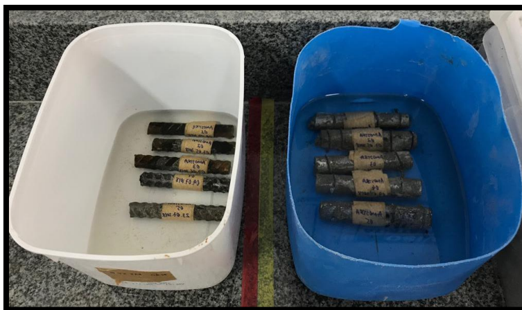
Figura 31 – Barras em ácido clorídrico a 0,05mol/L no início da análise.
