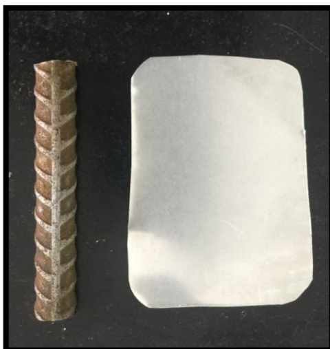
Figura 25 – Barra de ferro de 12,5 e chapa de alumínio 0,7 mm.
