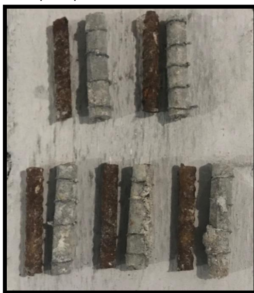
Figura 33 – Amostras que apresentaram corrosão no interior do concreto.
