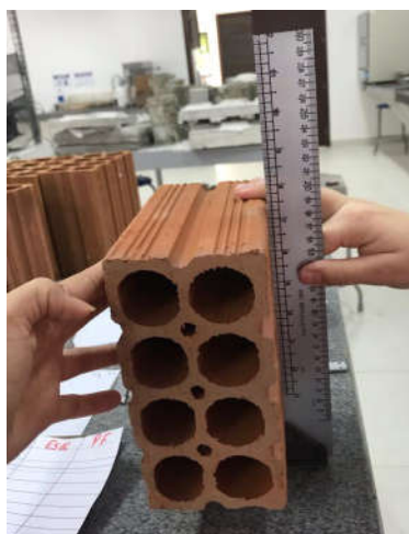
Figura 7 - Medição do desvio em esquadro
