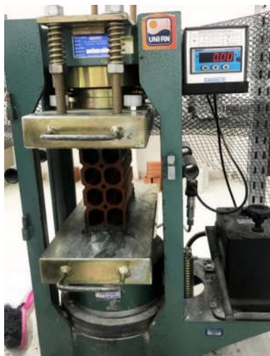
Figura 10 - Ensaio de compressão realizado em tijolos de vedação
