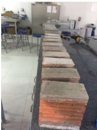
Figura 32 - Corpos de provas capeados no laboratório do UNI RN
