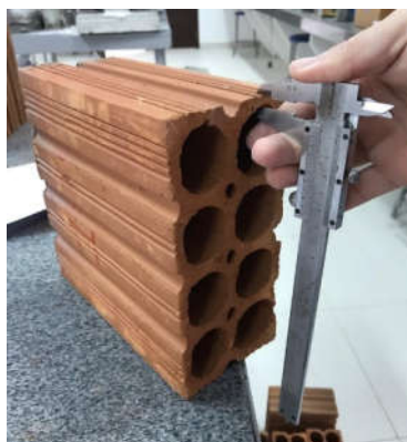
Figura 5 - Medição das paredes externas no laboratório de materiais
