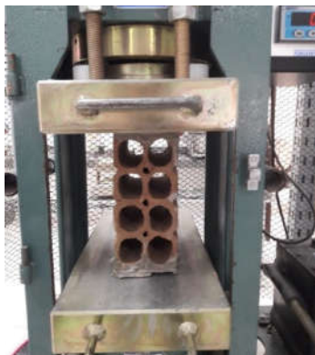
Figura 34 - Ensaio de compressão do tijolo de vedação
