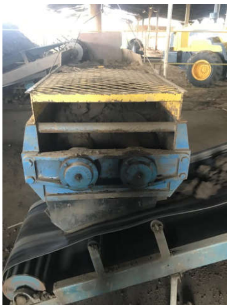
Figura 14 - Argila no misturador
