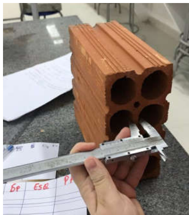
Figura 6 - Medição das espessuras dos septos no laboratório de materiais
