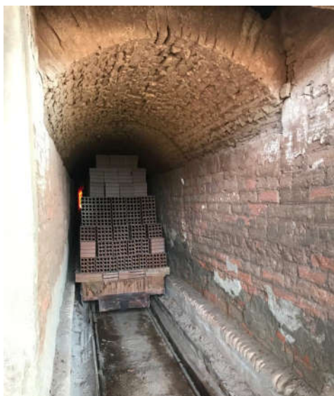
Figura 21 - Tijolos na zona de pré-aquecimento
