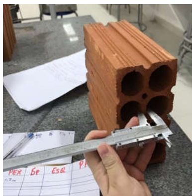
Figura 35 - Medição das espessuras dos septos no laboratório de materiais
