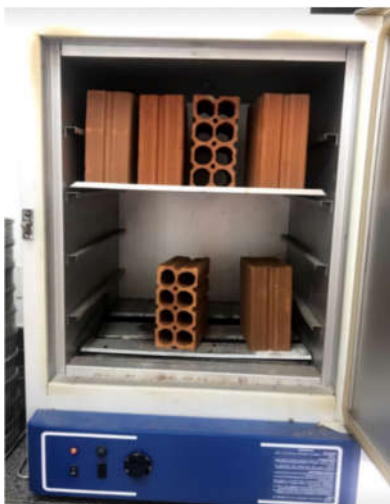
Figura 8 - Blocos na estufa, para obtenção da massa seca
