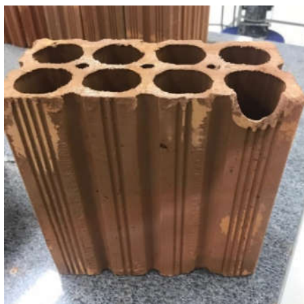
Figura 4 - Bloco de vedação com deformação
