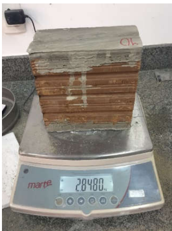
Figura 31 - Pesagem do corpo de prova saturado
