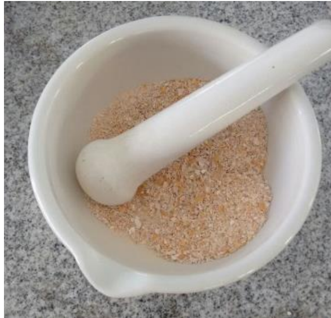
Figura 04 – Trituração da caca de caranguejo no Gral Ágata.
