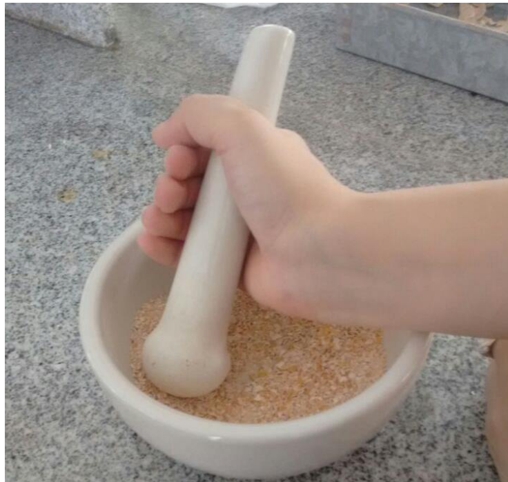
Figura 02 – Trituração das cascas no gral ágata.
