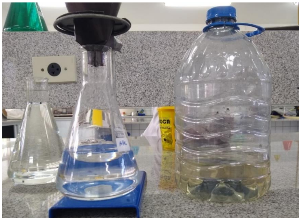
Figura 23 – Removendo quitosana com metais pesados da amostra.
