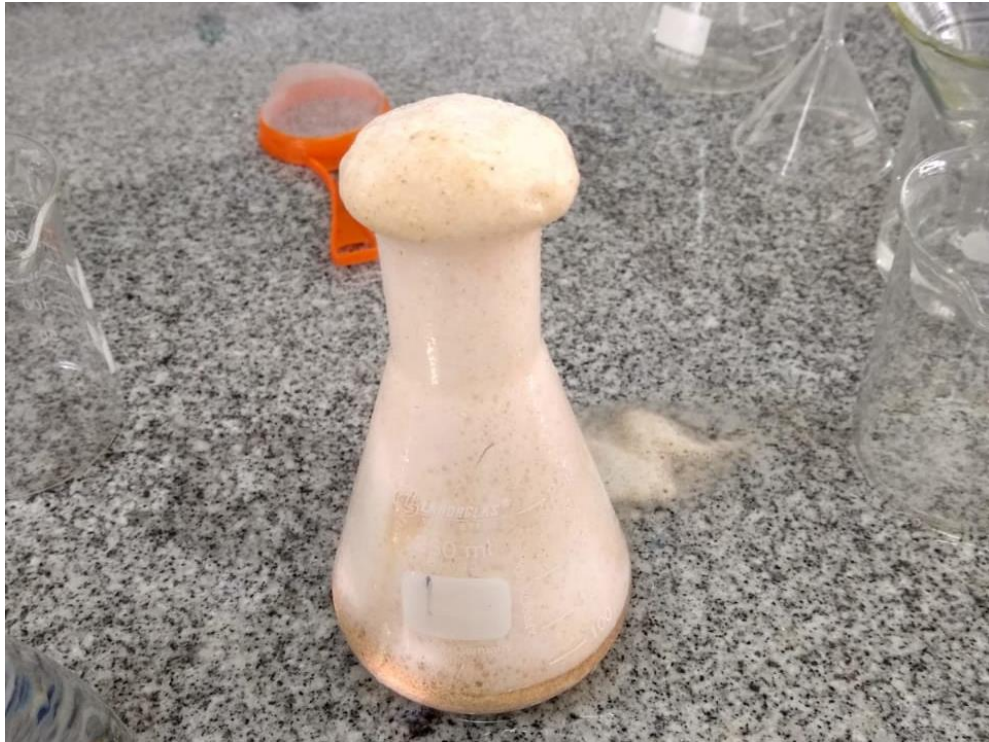
Figura 03 – Desmineralização do pó da casca do caranguejo com ácido clorídrico.
