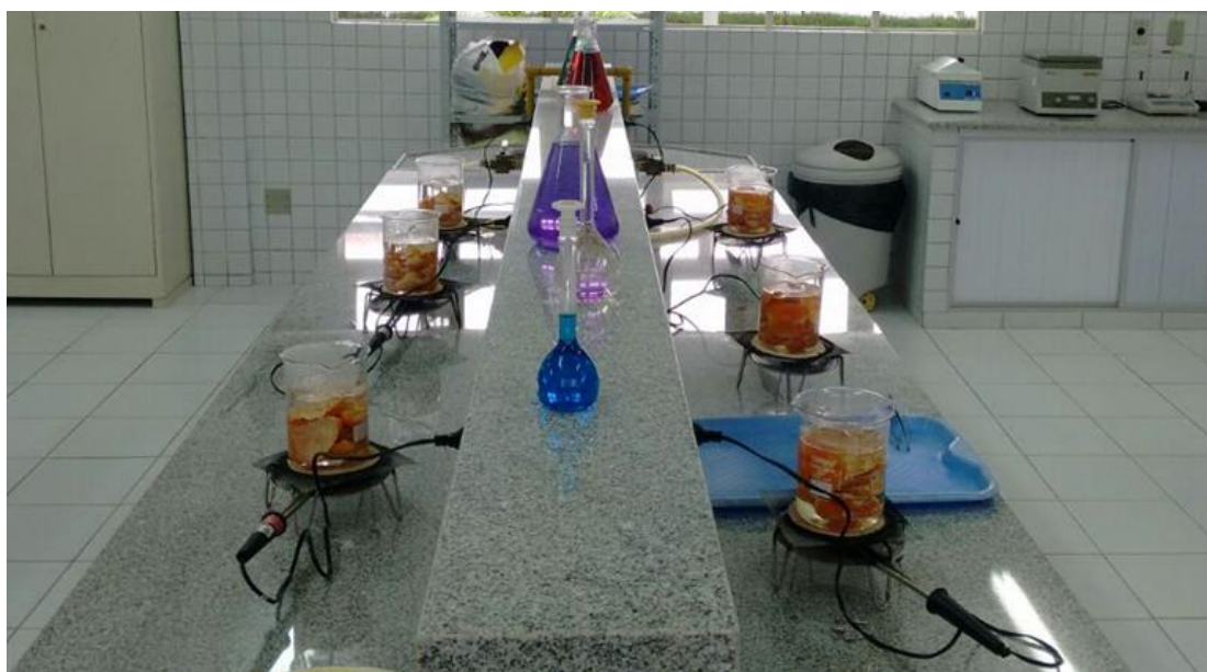
Figura 03 – Casca do caranguejo em béquer com água destilada fervente.
