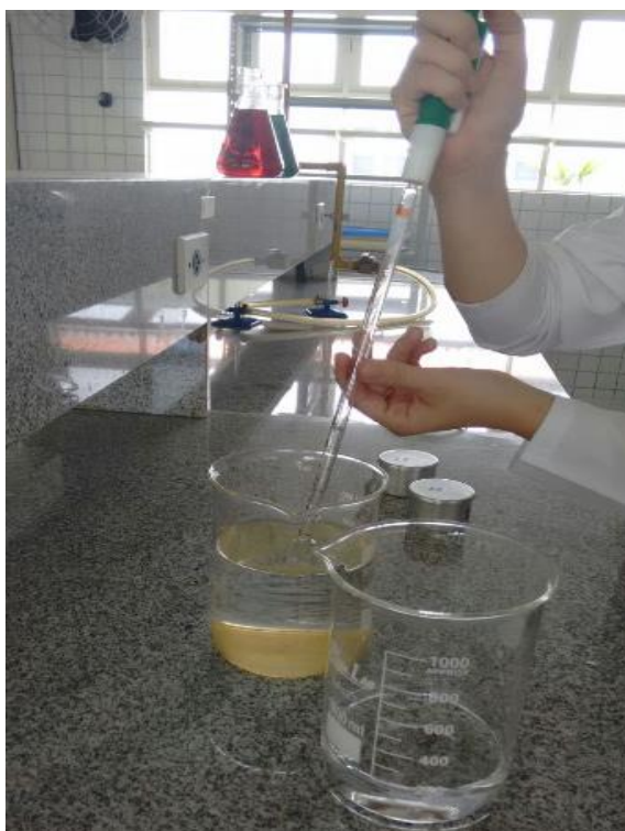
Figura 08 – Transferindo a água clarificada de um béquer a outro com o pepitador.
