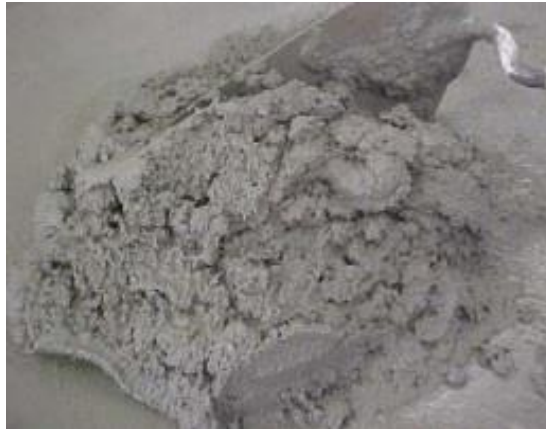
Figura 2 – Pasta de cimento e água
