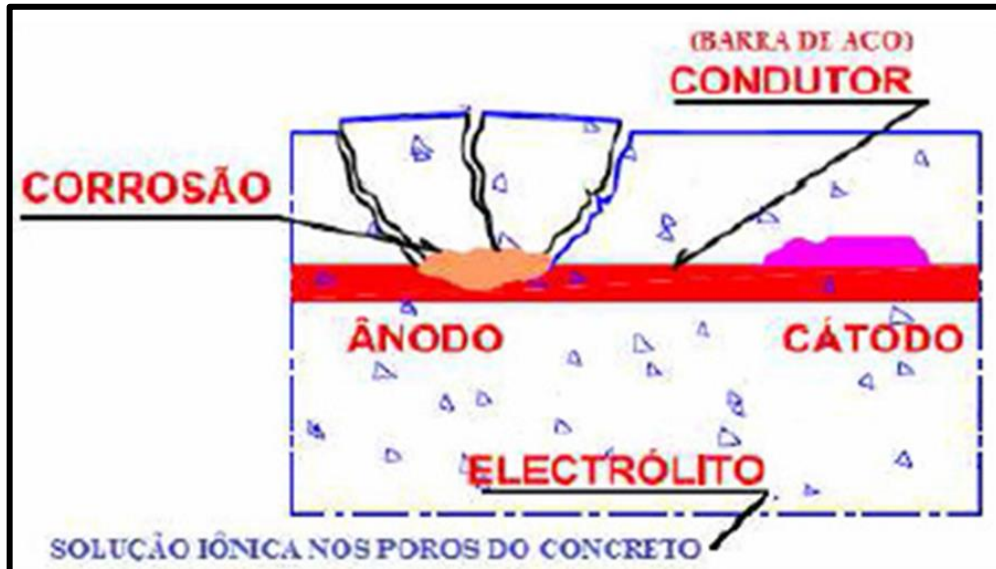
Figura 23 – Lascamento e destacamento do concreto
