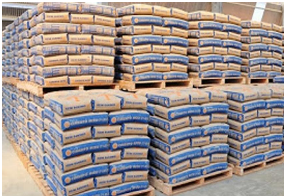
Figura 5 – Armazenamento de sacos de cimento
