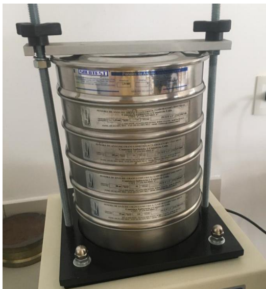
Figura 05 – peneiras em serie no agitador mecânico.
