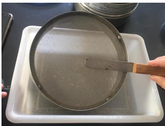
Figura 05 - Material retido na peneira sendo transferido para recipiente.
