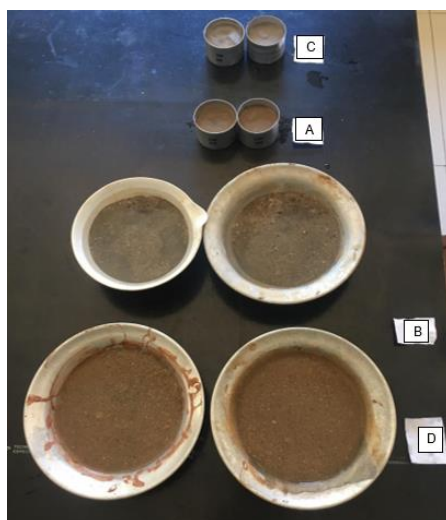
Figura 16 – Amostra com água pós lavagem depositada em recipientes.
