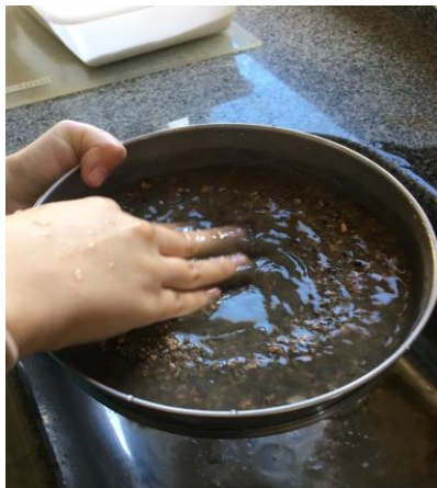
Figura 15 – Agitação da amostra com água na peneira de 75\mu\text{m} .
