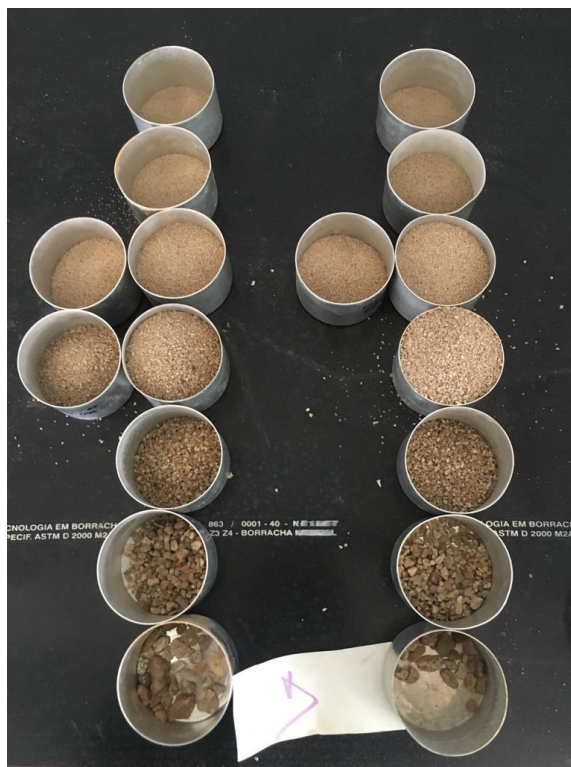
Figura 9 - Material coletado e pesado referente ao M1 e M2 da amostra D.
