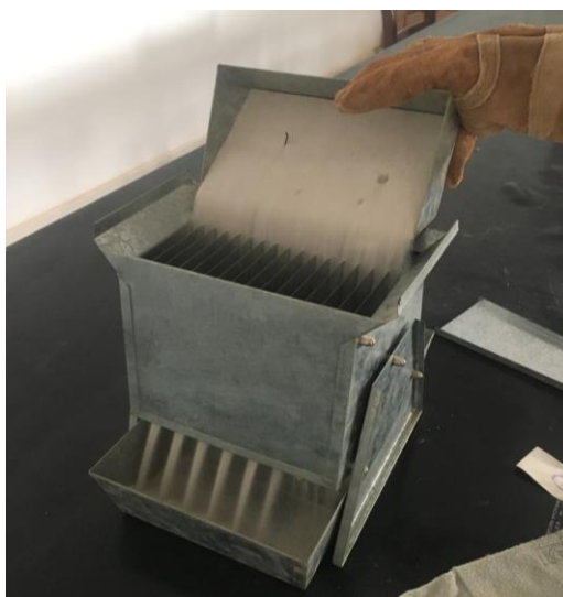
Figura 03 - Quarteamento das amostras para ensaio.
