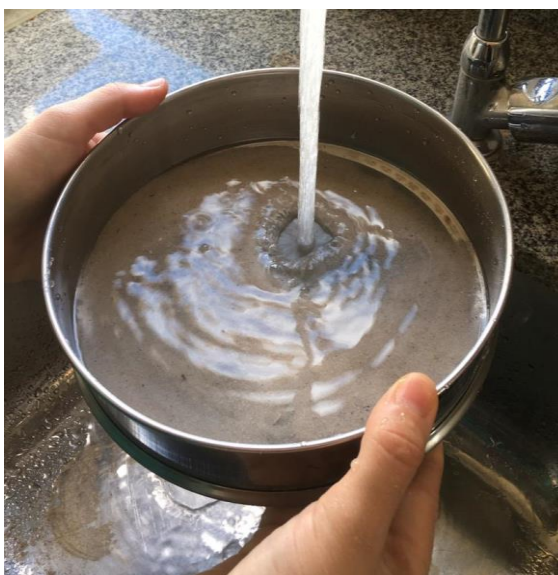
Figura 14 – Amostra na peneira de 75 \mu m com adição de água.
