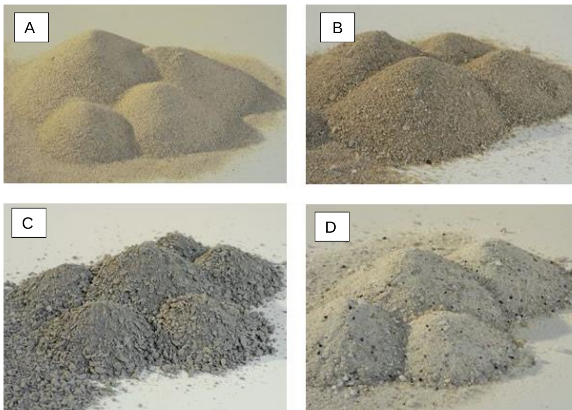
Figura 02 – Exemplos de Agregados Miúdos: A) Agregado miúdo fração areia fina; B) Agregado miúdo fração areia média; C) Agregado de brita fração areia média; D) Agregado de brita com mistura de frações de areia fina e média.
