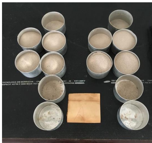
Figura 06 - Material coletado e pesado referente ao M1 e M2 da amostra A.
