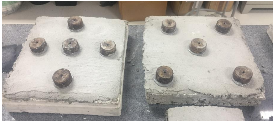
Figura 18- Pastilhas metálicas coladas na argamassa
