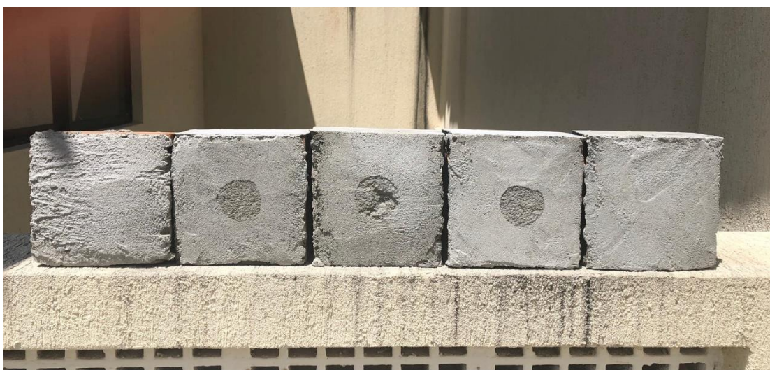
Figura 25- Aplicação de argamassa com adição de scheelita após 8 meses de exposição
