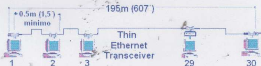
Figura 06: Topologia em barramento utilizando cabo coaxial fino
