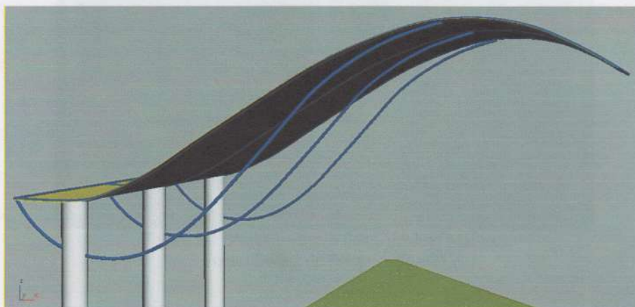
Figura 12: Posicionamento dos Suportes de Baixo da Cobertura
