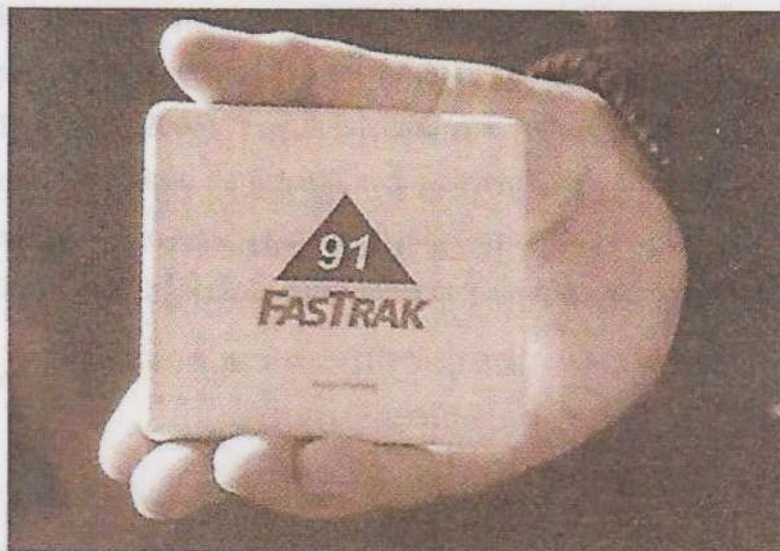
Figura 11: Dispositivo de identificação automática de veículos (IAV)
