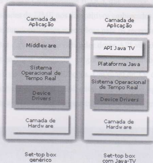
Figura 11: arquitetura de um set-top box genérico e um utilizando a tecnologia Java (SUN MICROSYSTEMS, 2003).
