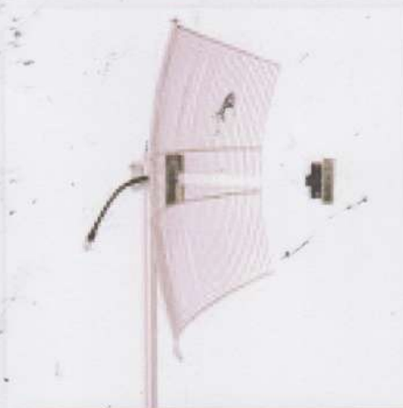
Figura 4: Antena parabólica de grade direcional de 25 dbi. Fonte: Antenas Aquário
