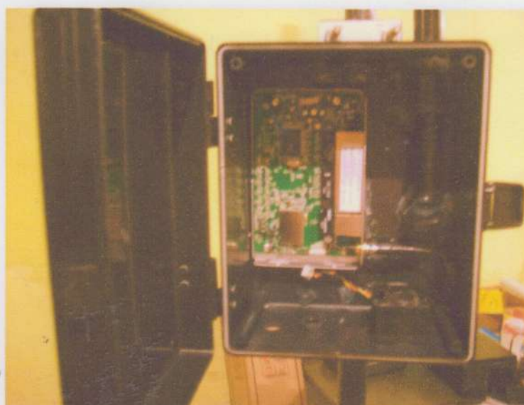
Figura 33: Caixa hermética com Access point montado para instalação na torre.
