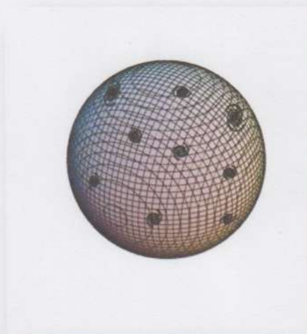
Figura 3: Diagrama de radiação de antena isotrópica. Fonte: Instituto de física da USP
