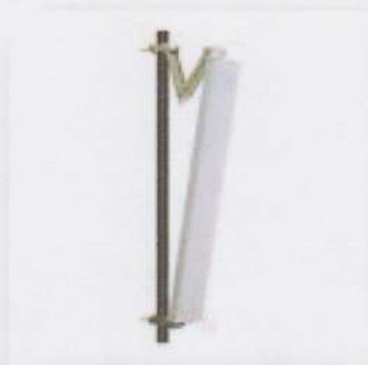
Figura25: Downtilt mecânico realizado em antena setorial.
