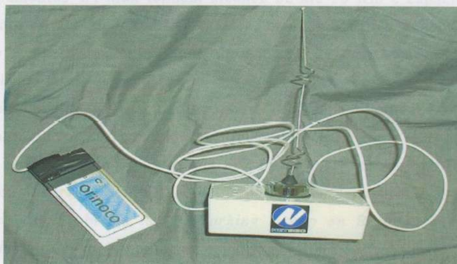
Figura 15: Antena com placa pemcia. Fonte: Kleber, 2007.
