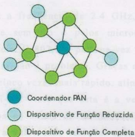
Figura 11: Topologia em Malha. Fonte: [IEEE 802.15.4, 2003]
