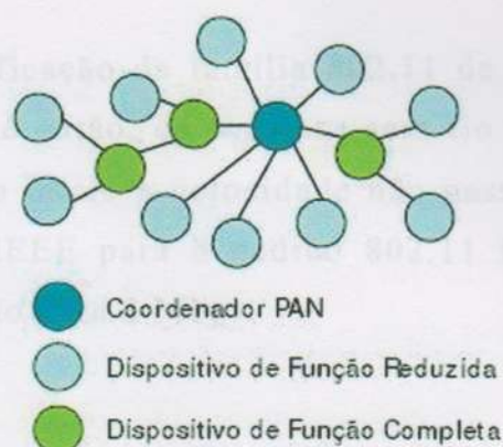
Figura 10: Topologia Cluster em Árvore. Fonte: [IEEE 802.15.4, 2003]
