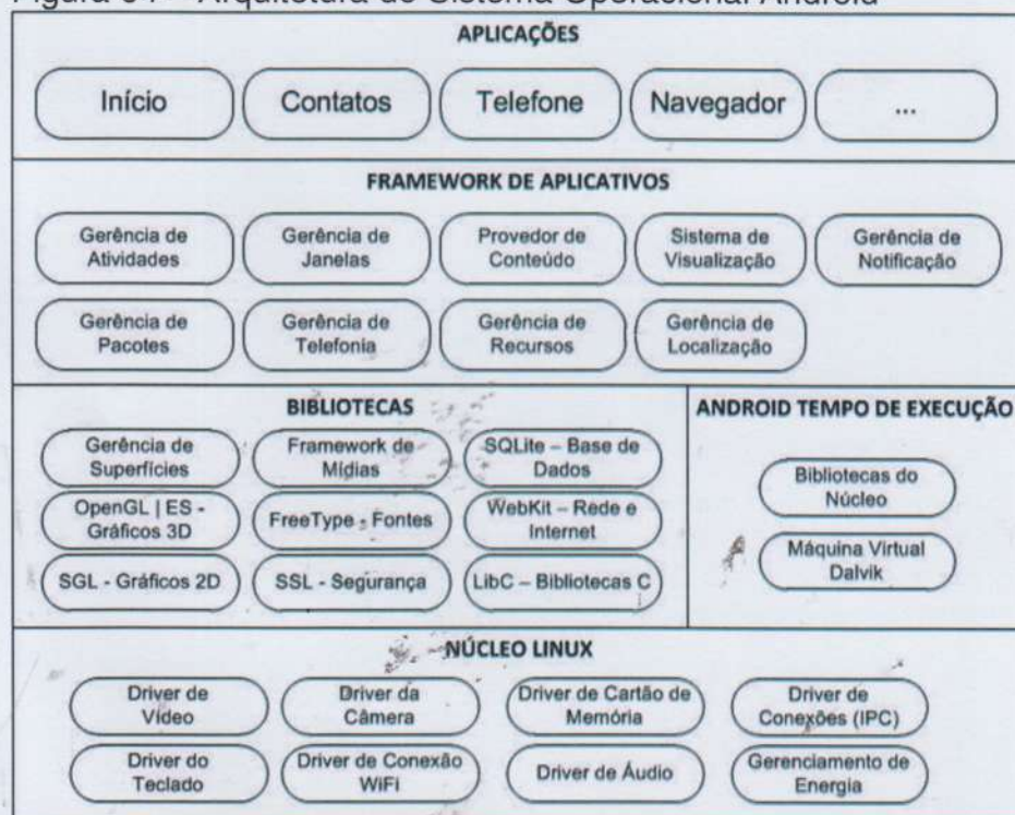
Figura 04 – Arquitetura do Sistema Operacional Android
