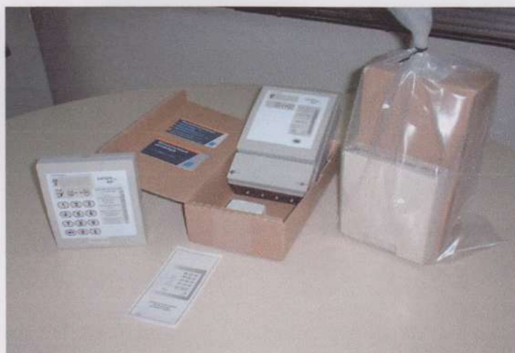
Figura 5 – Medidor, Unidade Split e cartão.
