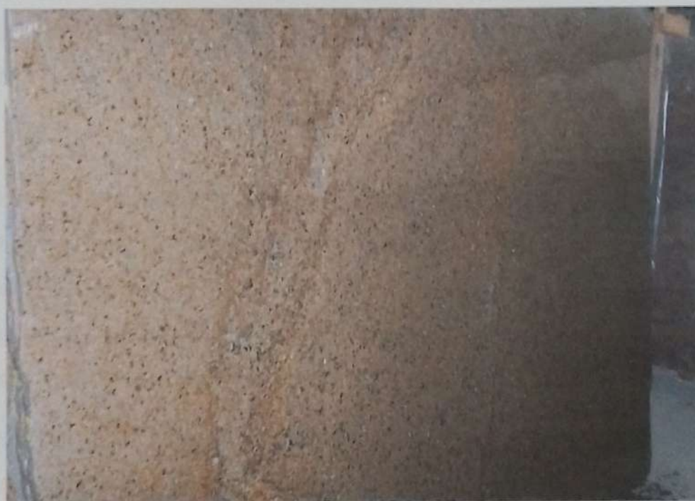
Figura 5: Bloco de Granito já transformado em Chapa e polido. Fonte: Imagens coletadas durante a pesquisa de campo.
