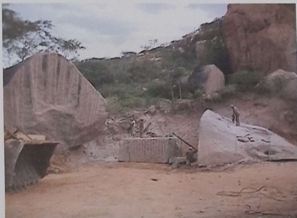
Figura 3: Extração do Bloco de Granito medindo aproximadamente 8m^3
