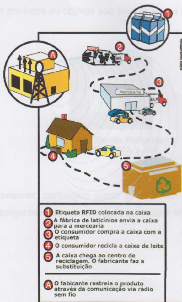
Figura 5: Fluxo de Informação - RFID Fonte: Bonsor (2008)
