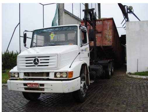
Figura 01 – O caminhão roll on-roll off coloca o contêiner vazio no fosso da Plataforma 01.
