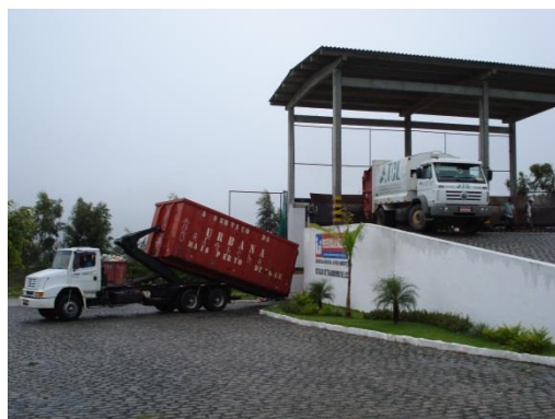
Figura 07 – O caminhão roll on-roll-off coloca o contêiner vazio, que estava no pátio de manobra, no fosso 01.
