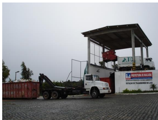
Figura 08 – O caminhão roll on-roll off carrega o contêiner carregado e segue para o aterro sanitário de Ceará – Mirim.
